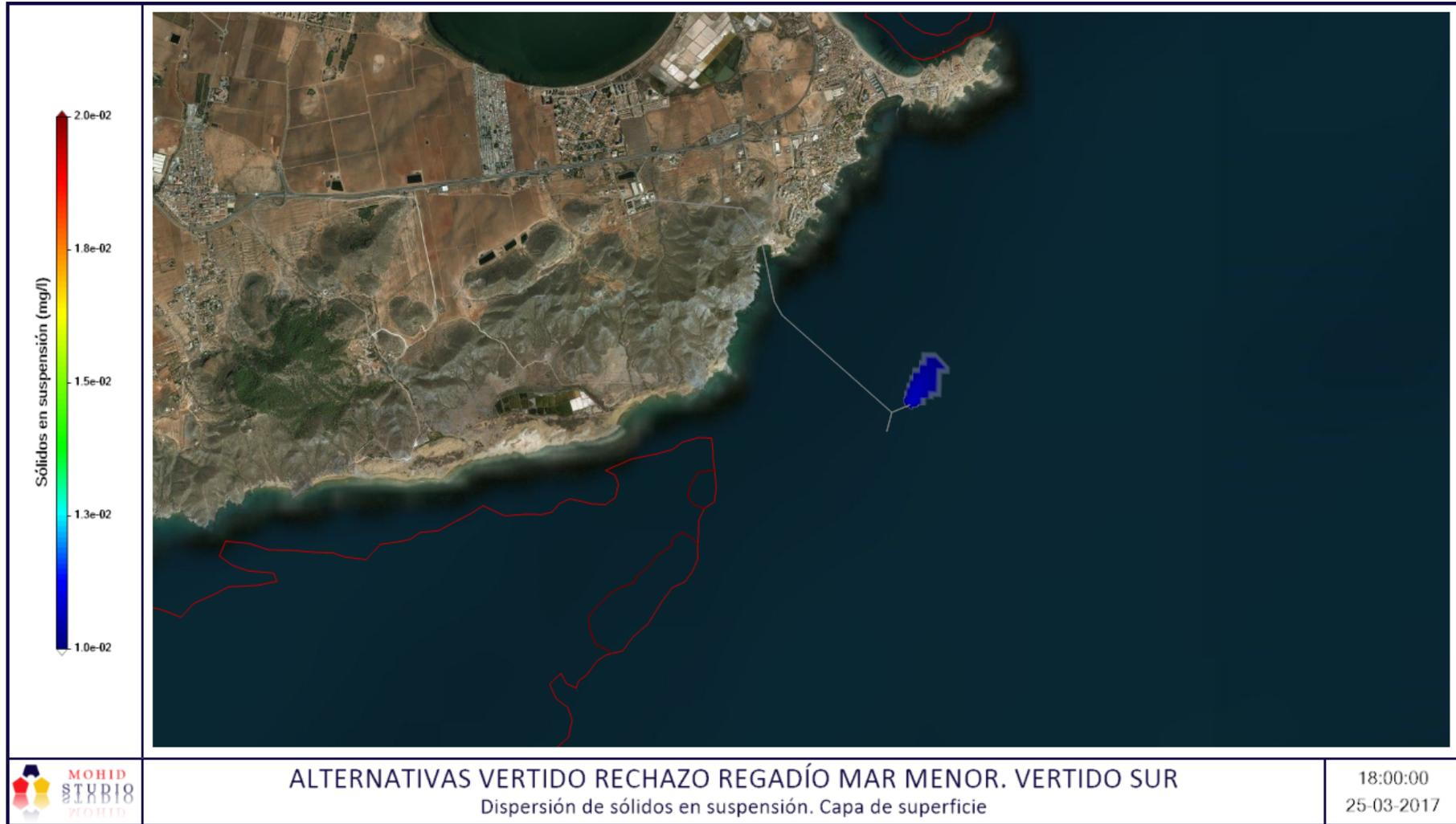
Figura 7: Máxima aproximación al NE en la capa de superficie. Contaminante: Sólidos en suspensión
