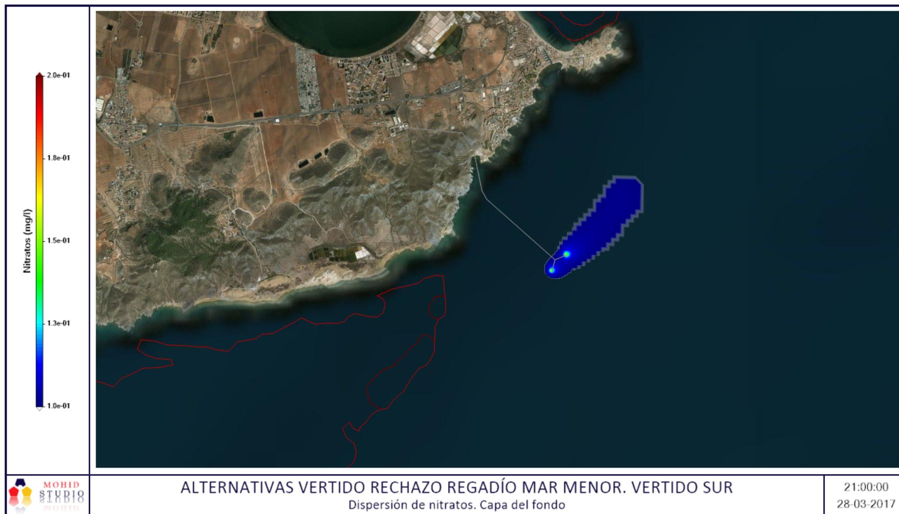
Figura 1: Máxima aproximación al NE en la capa del fondo. Contaminante: Nitratos
