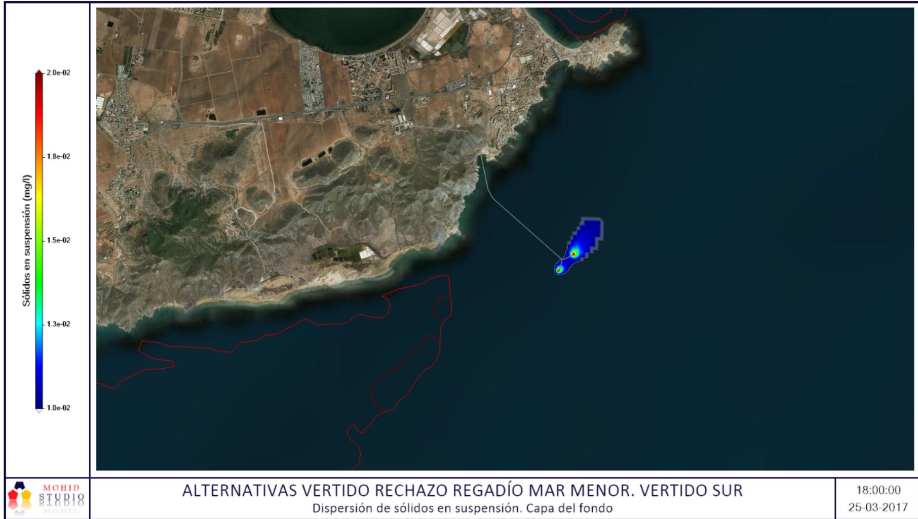
Figura 5: Máxima aproximación al NE en la capa del fondo. Contaminante: Sólidos en suspensión
