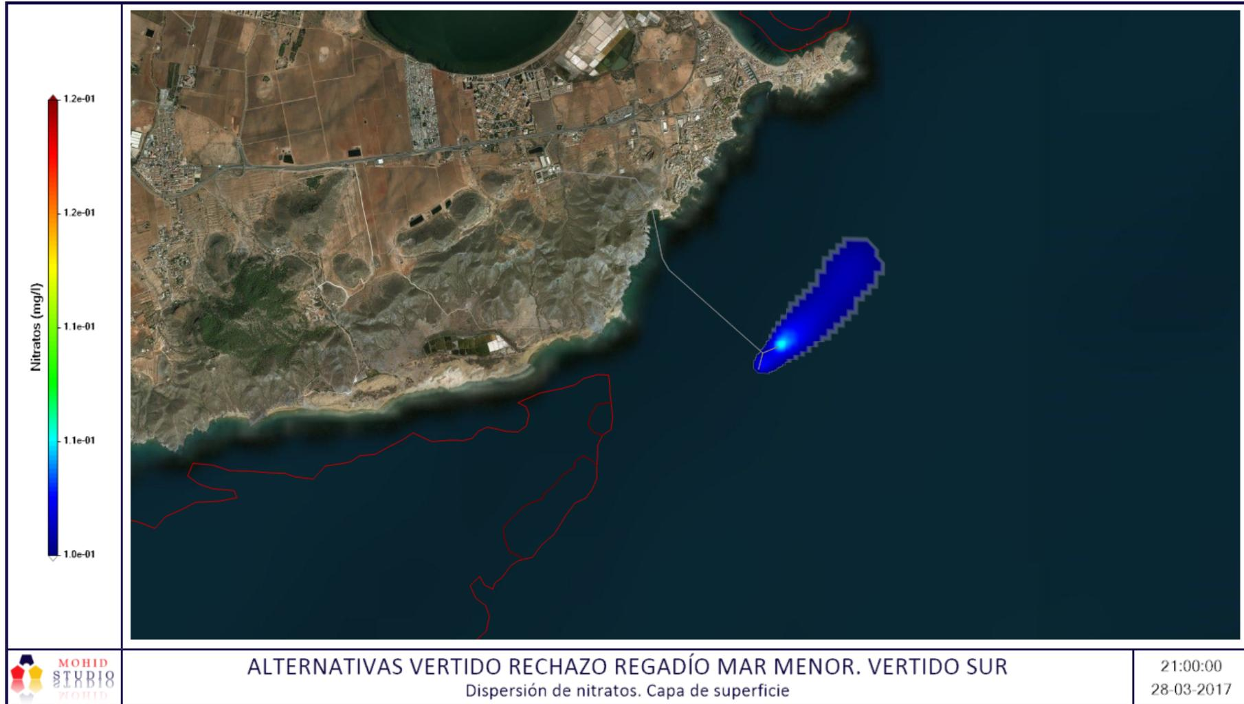
Figura 3: Máxima aproximación al NE en la capa de superficie. Contaminante: Nitratos
