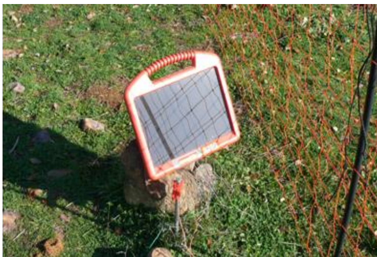
Detalle de energizador Koltec S500.
