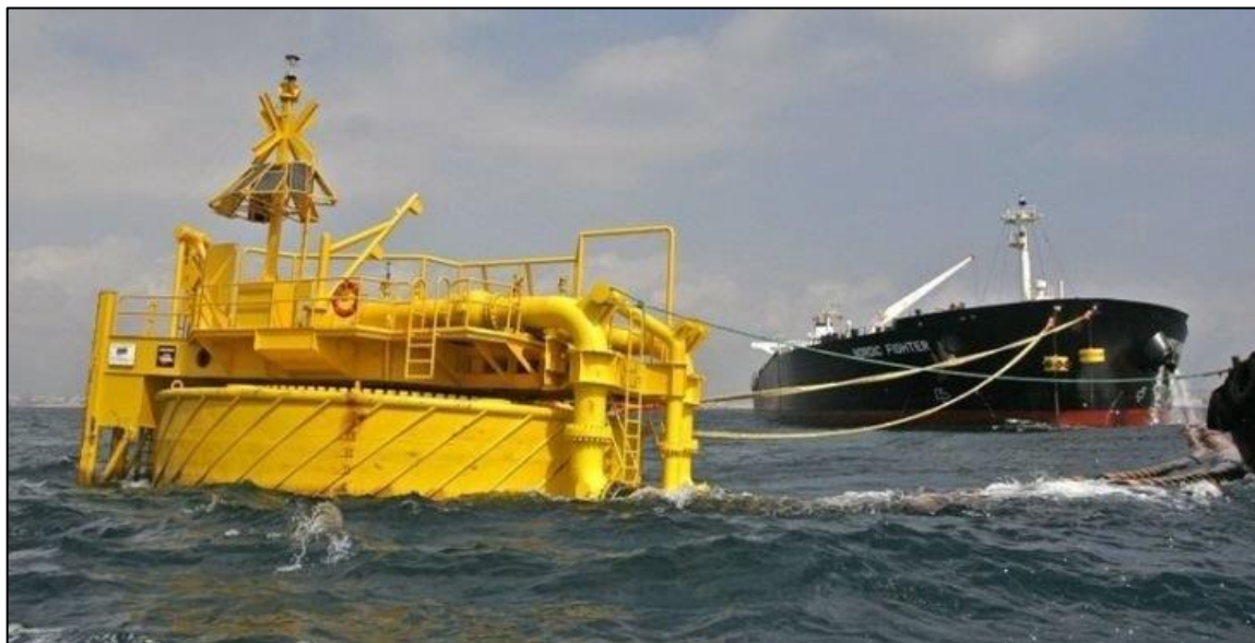
Figura 147. Imagen de la monoboia de la bahía de Algeciras con un buque descargando (Fuente: Estrella Digital)
