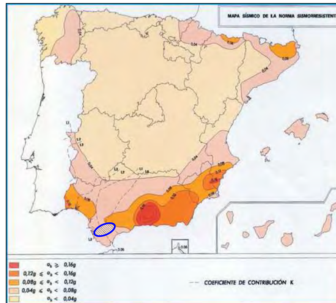
Figura 9. Mapa de peligrosidad sísmica. Mapa de valores de la aceleración sísmica básica. y localización del proyecto. Fuente: Norma sismorresistente NCSE-02
