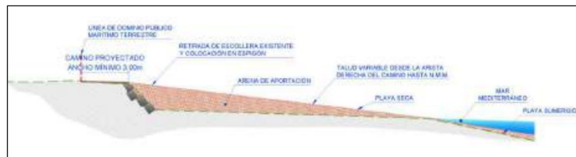
Figura 5. Sección tipo regeneración
