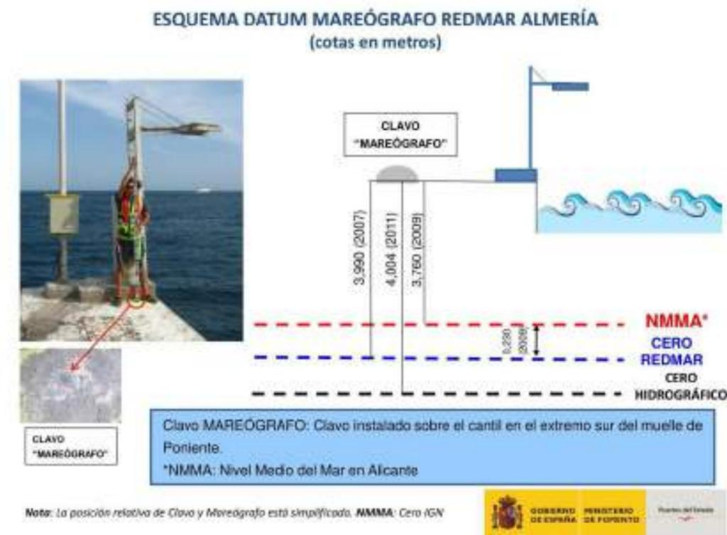
Figura 31. Esquema DATUM mareógrafo REDMAR ALMERIA
