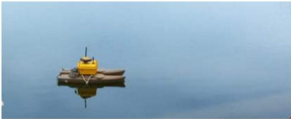
IMAGEN 1: Drone Náutico equipado con GPS y ecosonda.
