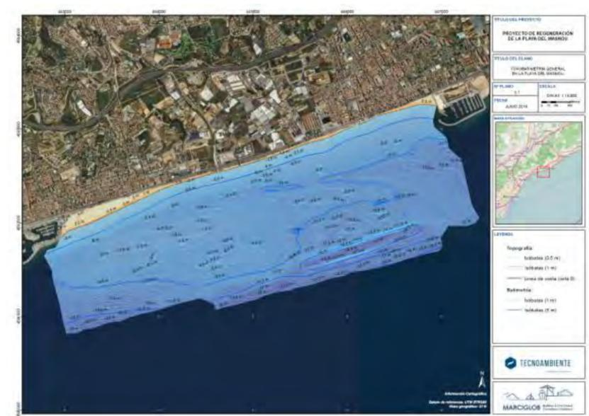
Figura 3.- Resultados del levantamiento topográfico y batimétrico (Fuente: Tecnoambiente)
