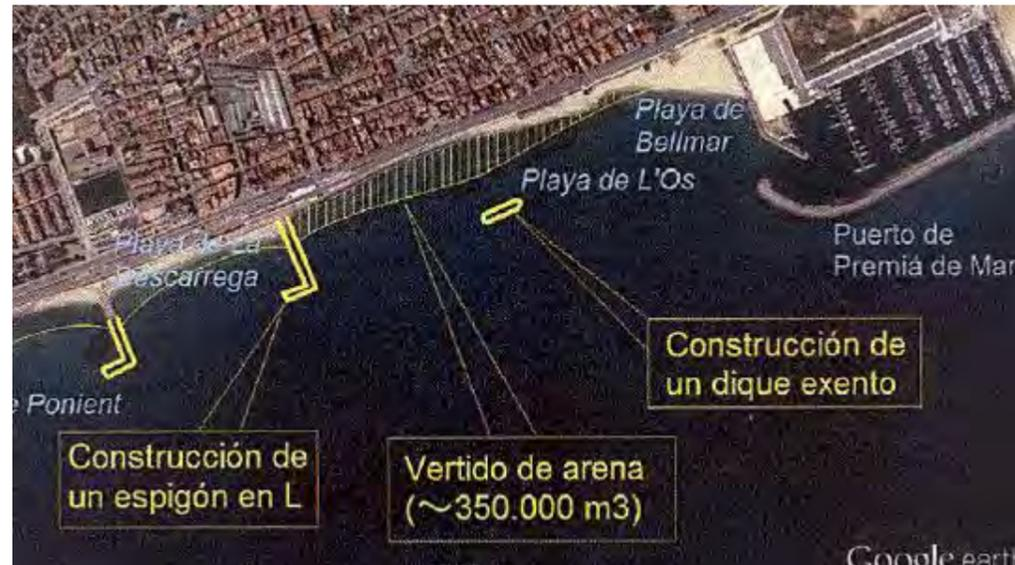
Figura 2.- Alternativa de la actuación 1 con espigón exento sugerida en el informe del CEDEX. (Fuente: CEDEX)
