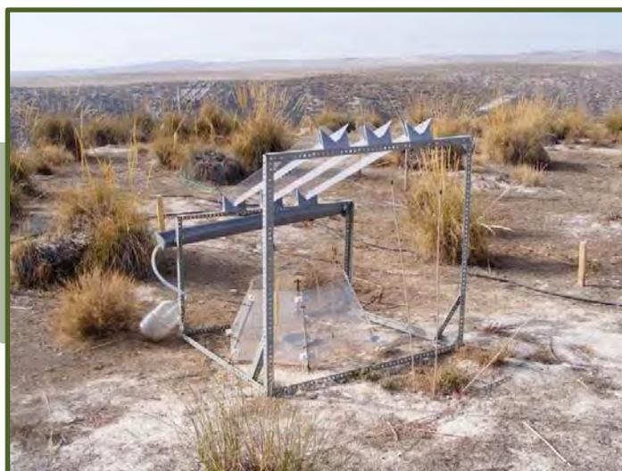
▲ Figura 3. Reductores de precipitación y cúpula de metacrilato inductora de calentamiento en la parcela experimental de Aranjuez.
