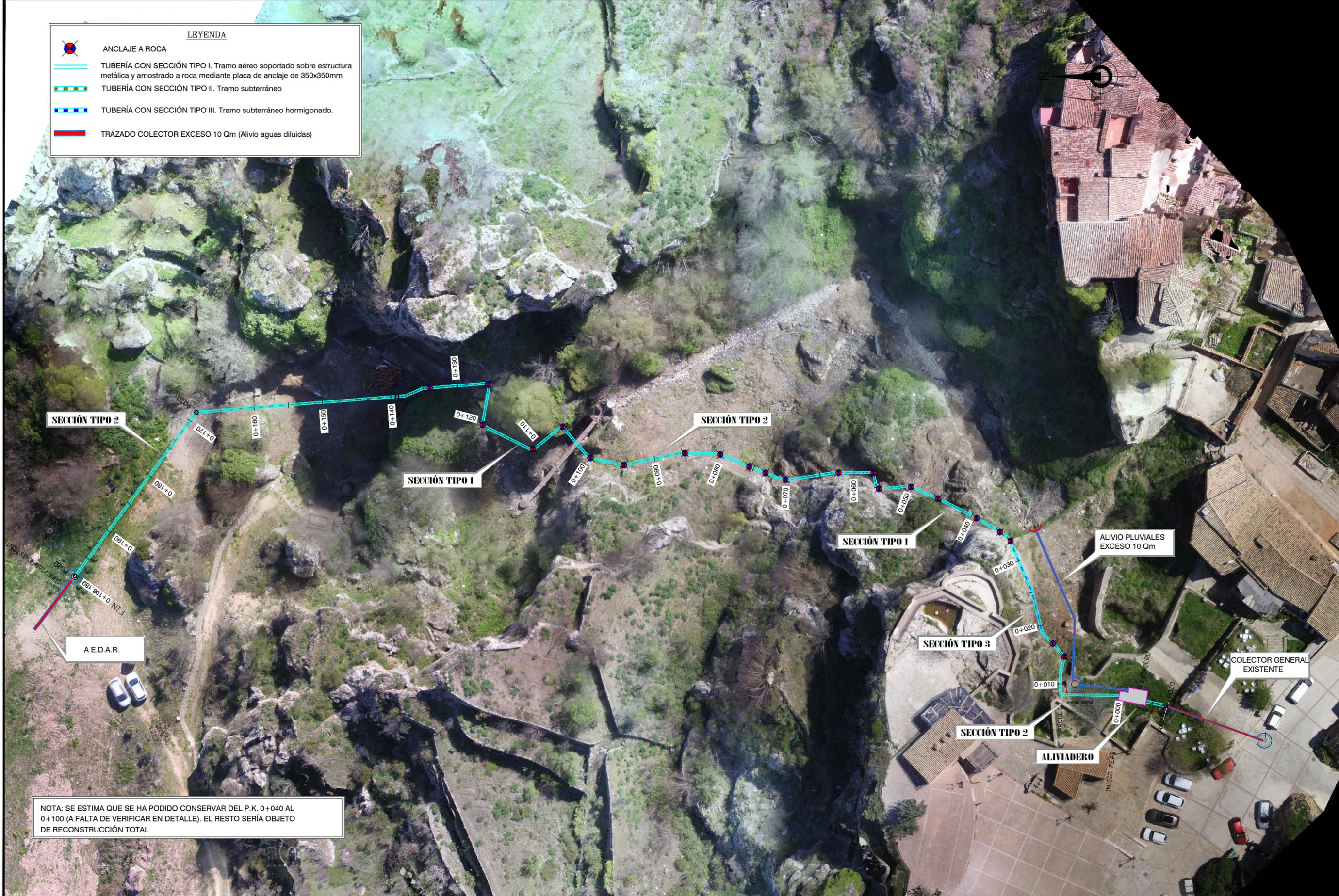
NOTA: SE ESTIMA QUE SE HA PODIDO CONSERVAR DEL P.K. 0+040 AL 0+100 (A FALTA DE VERIFICAR EN DETALLE). EL RESTO SERÍA OBJETO DE RECONSTRUCCIÓN TOTAL
