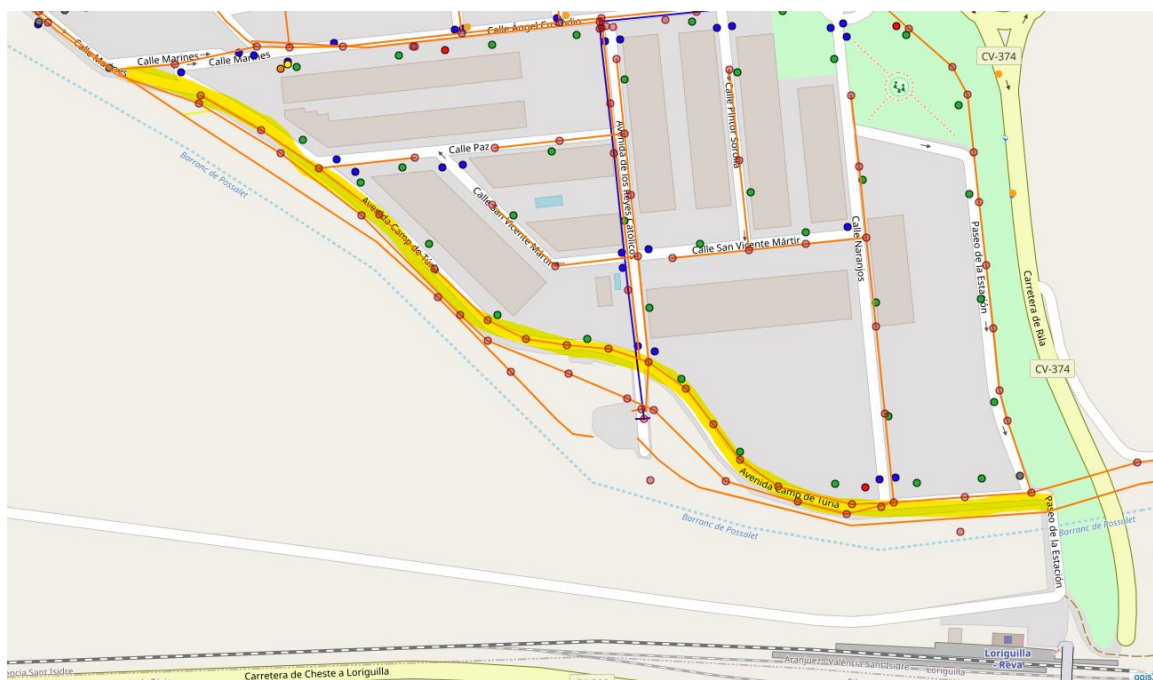
Figura 3. Tramo de red de alcantarillado afectado por la DANA
