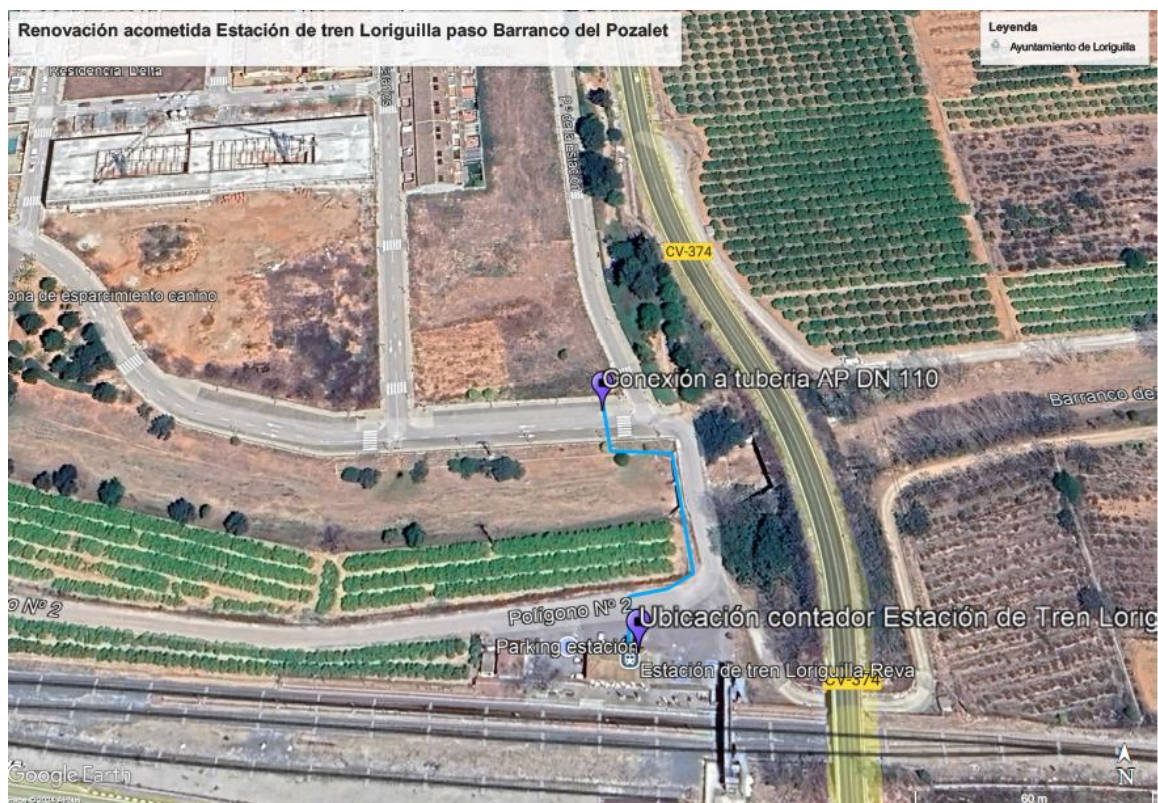
Figura 6. Acometida Estación Ferroviaria agua potable a renovar.
