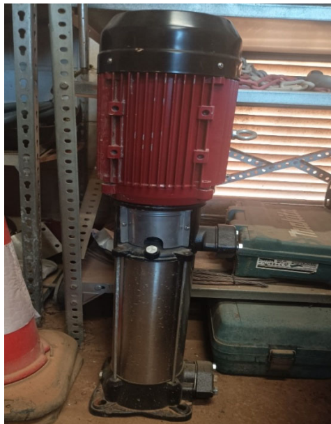
23.-BOMBA DE RIEGO
