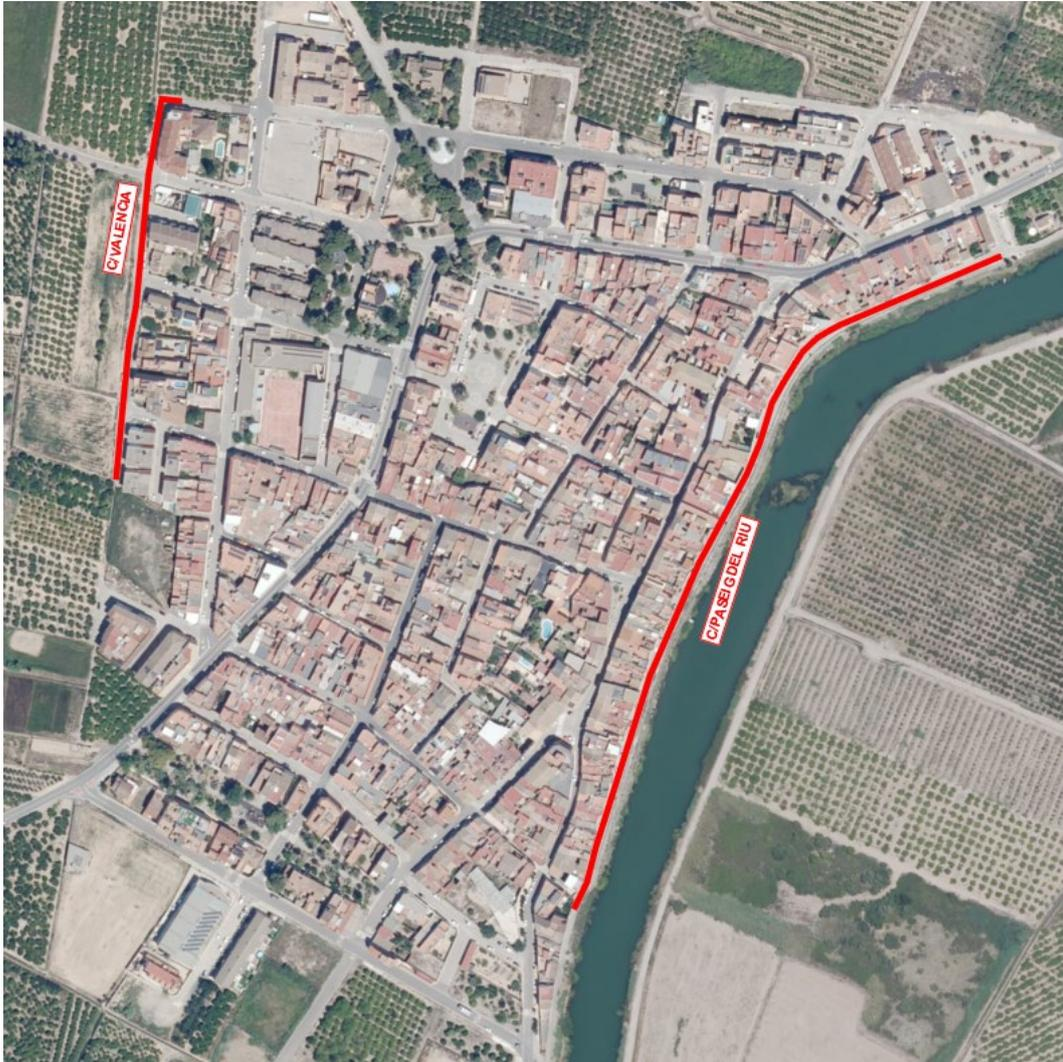
En primer lugar se recorre la calle Passeig del Riu. Bajo esta calle discurre un colector unitario que tiene varios puntos de descarga al río que se gestionan mediante tajaderas. Cuando el caudal que circula por la red es elevado, el colector, de 500 mm de diámetro, almacena parte del agua y si no es suficiente se abren las tajaderas para evitar que la red entre en carga.
