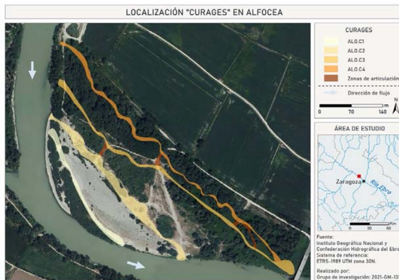
Figura 11.2. Brazos recuperados en el meandro del Soto de Alfoceda (Cuartero et al , 2022).
