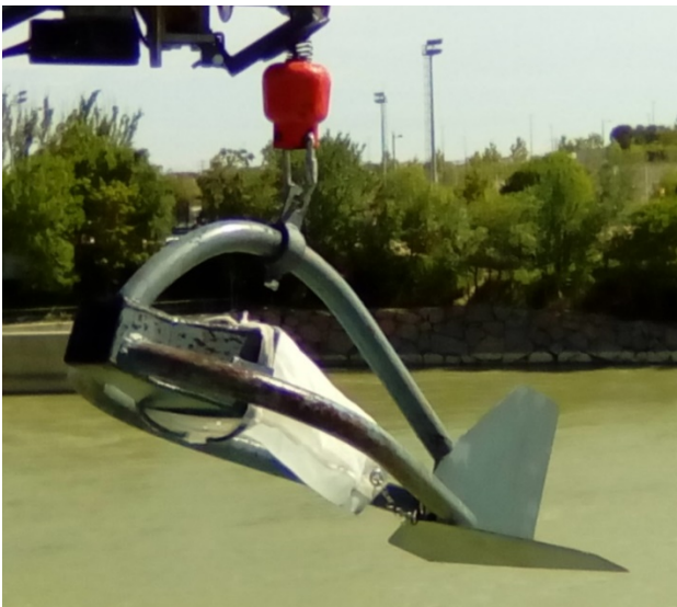
Figura 9.2. Izado del aparato de medidas Helley-Smith durante el muestreo del transporte de fondo de mayo de 2018.
