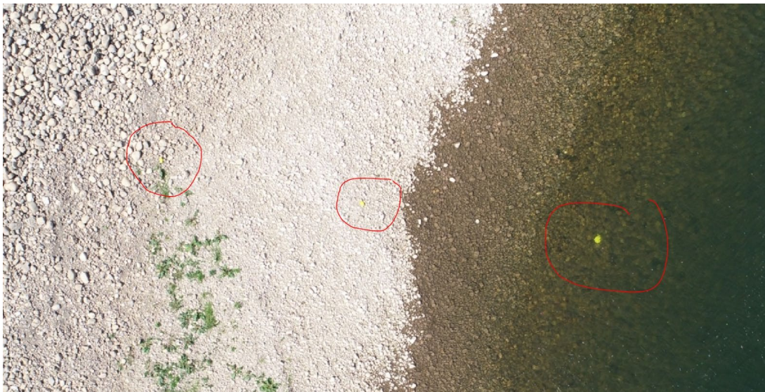
Figura 12. Imagen de vuelo dron con un transepto de clastos trazadores remarcados con círculo rojo.
