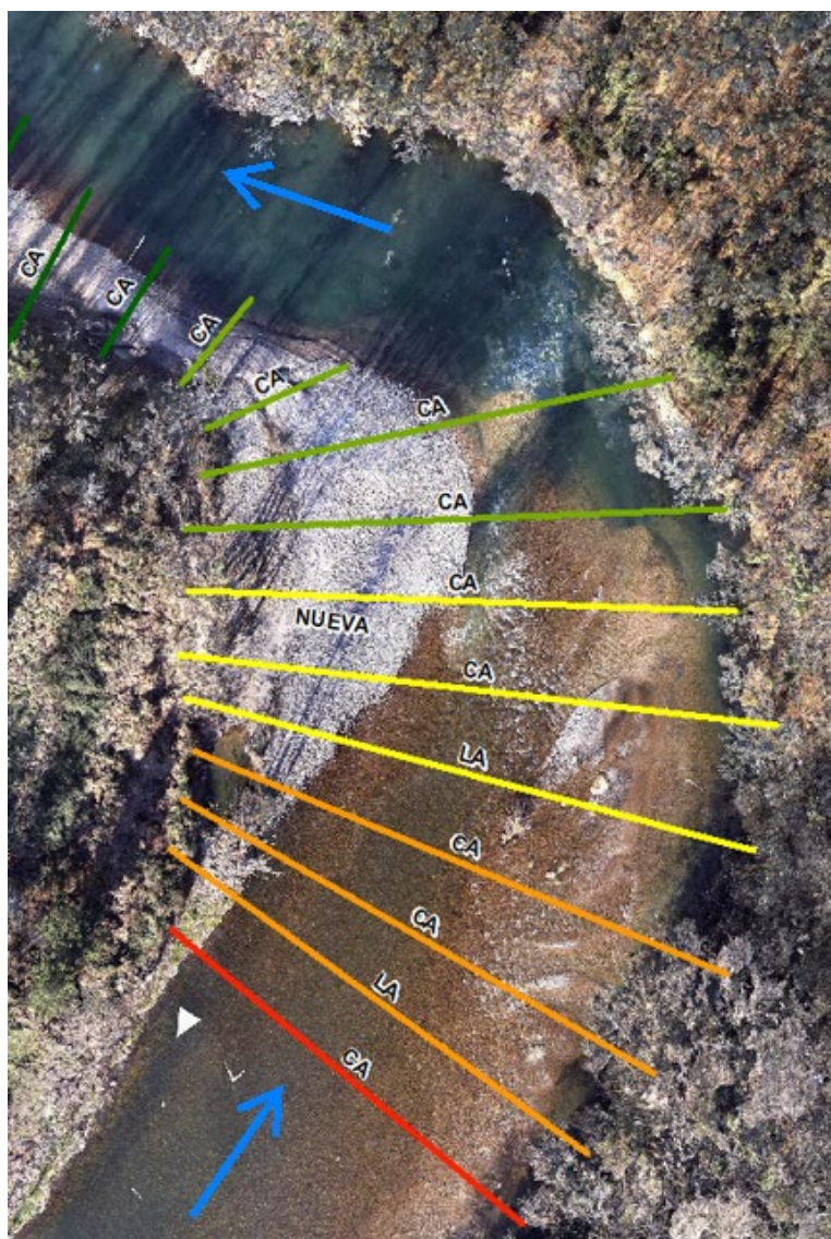
Figura 11. Perfiles de distribución de trazadores RFID, desde tamaños de clasto mayores en los perfiles aguas arriba desde 128, 90 de eje b (colores rojos y naranjas) hacia los más pequeños de 64, 45 y 32 mm (amarillos y verdes).
