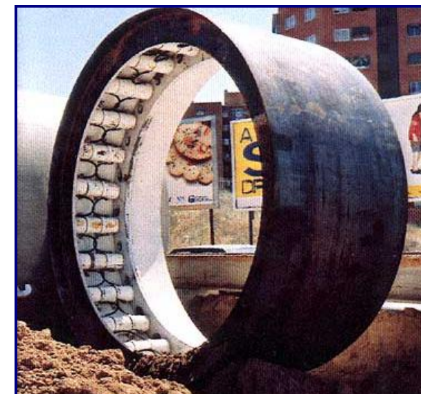
Imagen 17. Virola que se utiliza para crear la estación intermedia
