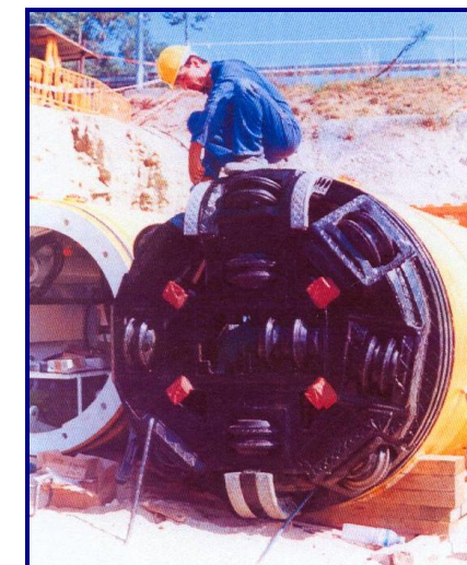
Imagen 26. Cabeza de corte en roca
