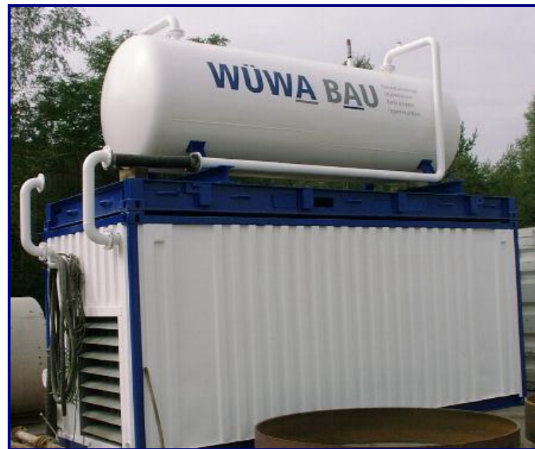
Imagen 31. Planta de decantación del detritus
