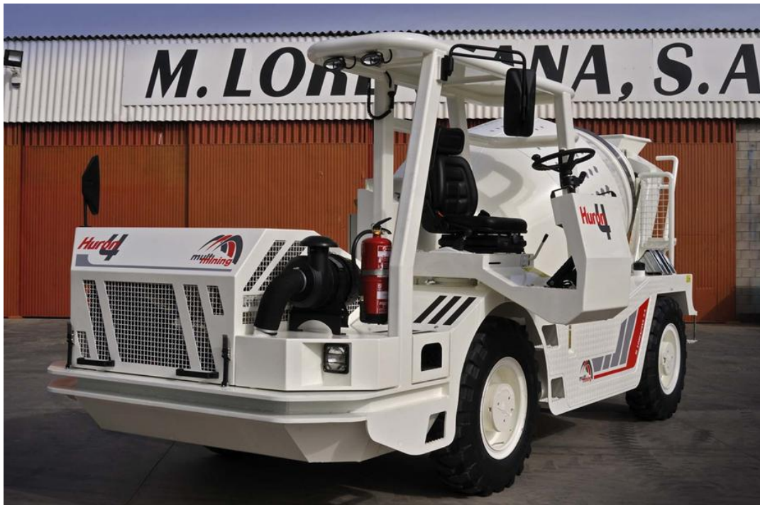
Imagen 41. Mezcladora de perfil bajo tipo Lorenzana Hurón 4
