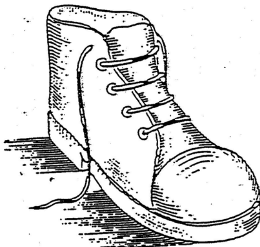
PUNTERA DE ACERO DE 1,8 mm. DE ESPESOR PLANTILLA DE ACERO DE 0,50 mm. DE ESPESOR. PUNTERA DE GOMA EXTERIOR.
