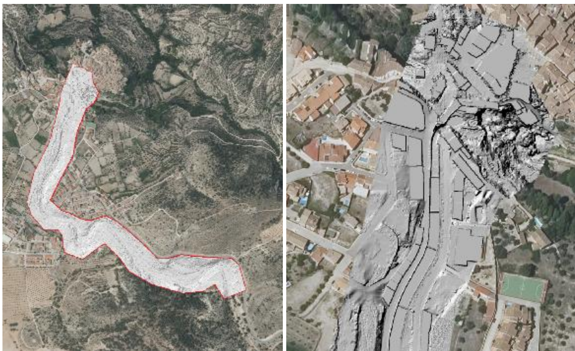
Figura 61. Modelo digital del terreno elaborado a partir de los datos brutos LAS del vuelo dron realizado el 27 de marzo de 2025
