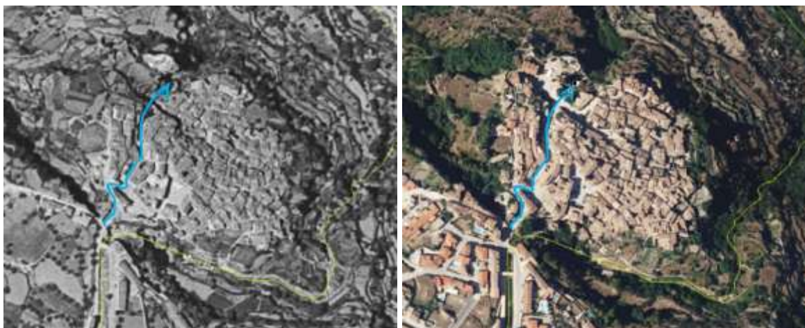
Figura 43. Dirección que lleva el agua en avenidas de gran magnitud sobre ortofoto 1956 (izquierda) y actual (derecha)
