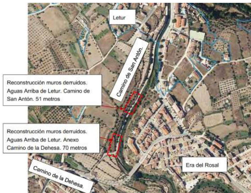
Figura 13. Zonas de desbordamiento del cauce a la carretera San Antón que han requerido la reconstrucción de los muros colapsados. Fuente: Obra de emergencia de los trabajos de retirada de arrastres y reparación del encauzamiento del arroyo Letur. CHS
