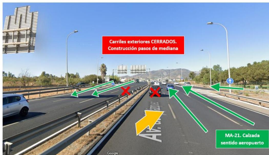
Figura 82. MA-21. p.k. 3+780. Esquema de circulación en calzada sentido aeropuerto durante los trabajos de construcción del paso de mediana provisional. Fuente: Google maps 2024.
