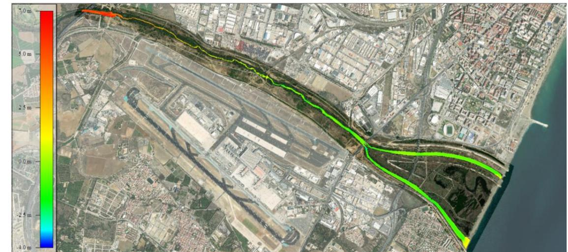
**Figura 128. MDT obtenido de la batimetría en el cauce del río Guadalhorce**
