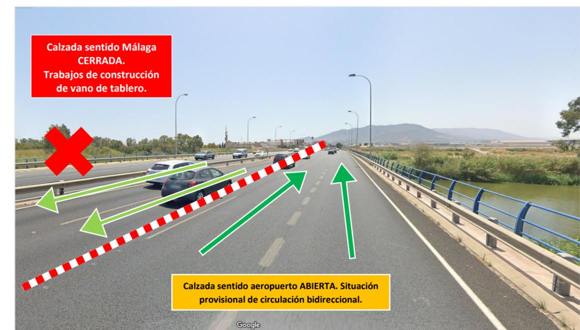
Figura 86. MA-21. Trabajos de construcción de vano de tablero. Esquema de circulación provisional en calzada sentido aeropuerto. Fuente: Google maps 2024.
