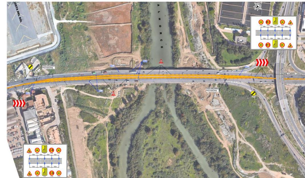
Figura 83. Soluciones al tráfico en Fase A. Señalización de obras según esquema 3.18 modificado con obras ocupando el carril izquierdo de cada sentido. Fuente: Plano 4.4.3.1
