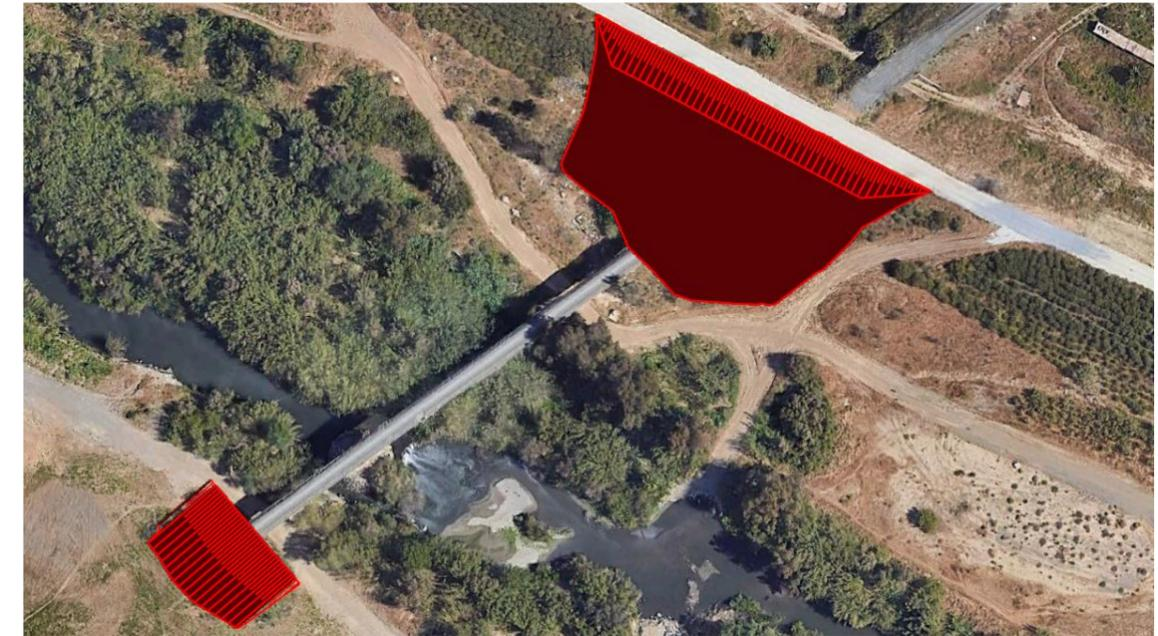
Figura 114. Actuación 9. Excavación terraplenes estructura ferrocarril. Fuente: Elaboración propia.
