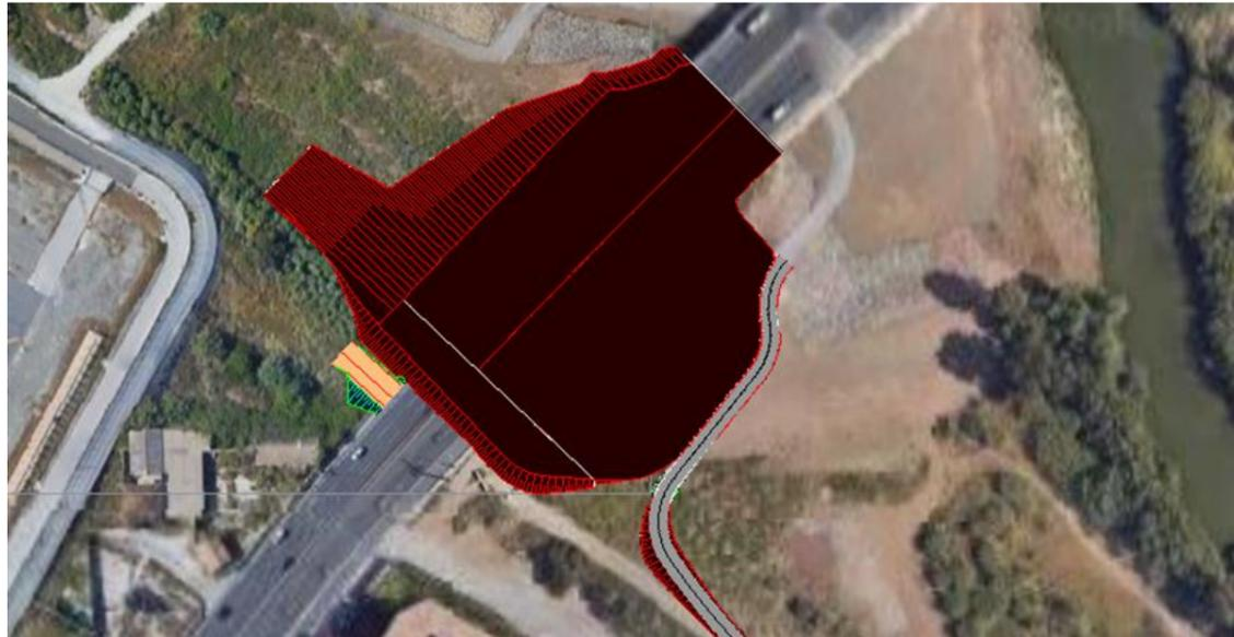
Figura 90. Actuación 5. Excavación terraplén en zona de nueva estructura. Fuente: Elaboración propia.
