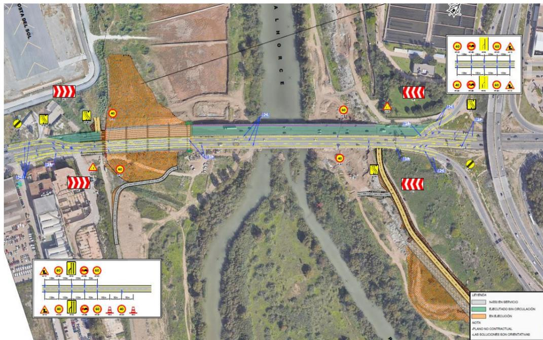
Figura 85. Soluciones al tráfico en Fase B. Señalización de obras según esquema 3.16 modificado con obras ocupando el carril izquierdo de cada sentido. Fuente: Plano 4.4.3.2
