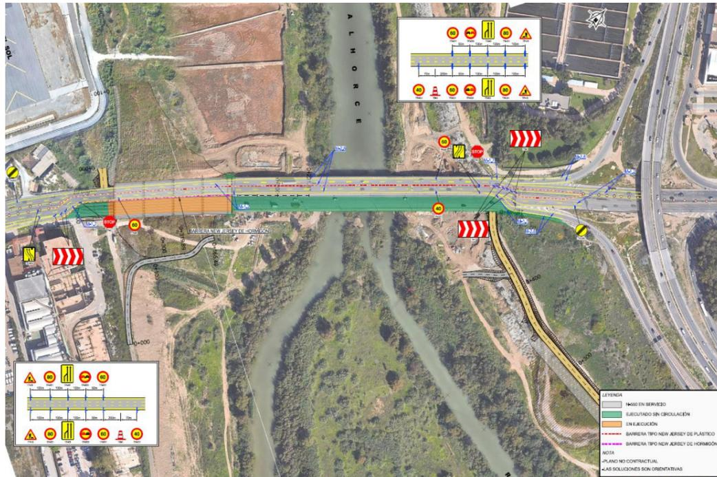
Figura 87. Soluciones al tráfico en Fase C. Señalización de obras según esquema 3.16 modificado con obras ocupando el carril izquierdo de cada sentido. Fuente: Plano 4.4.3.3
