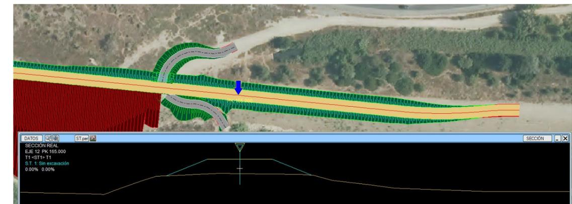
Figura 47. Representación transversal de la mota elevada evitando ocupaciones en la margen derecha. Fuente: Elaboración propia.
