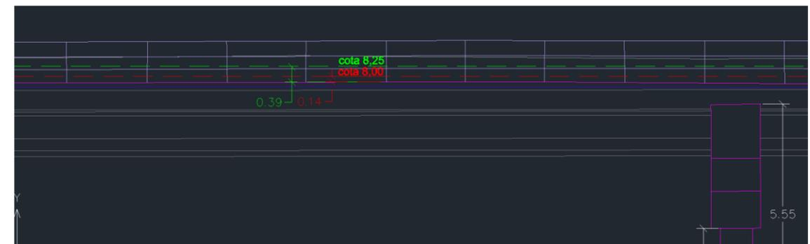
Figura 96. Detalle vano 6 (zona central). Alturas necesarias murete (39 y 14 cm) para alcanzar cotas 8,25 msnm y 8,00 msnm respectivamente.
