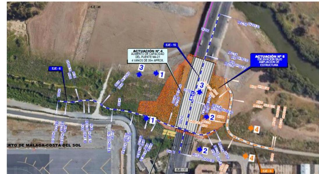
Figura 88. Actuación 5. Excavación terraplén en zona de nueva estructura. Fuente: Elaboración propia.
