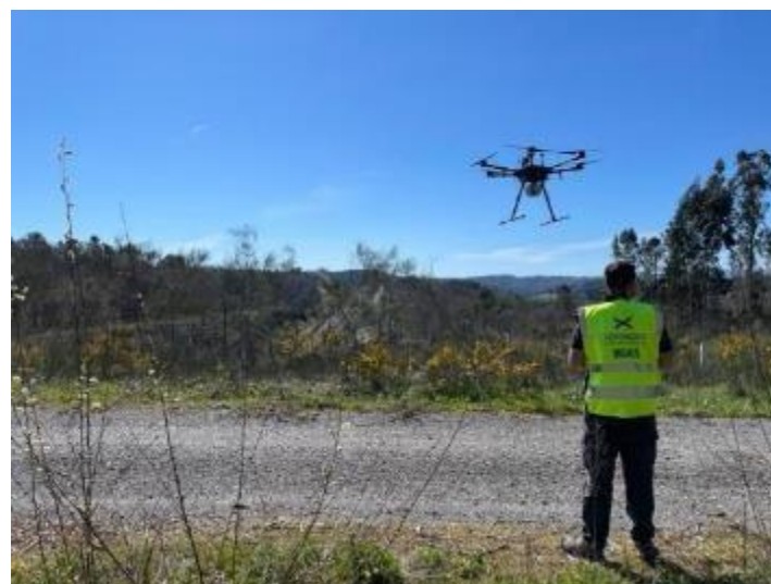
Ilustración 4 Modelo de solución RPAS+LiDAR empleado.
