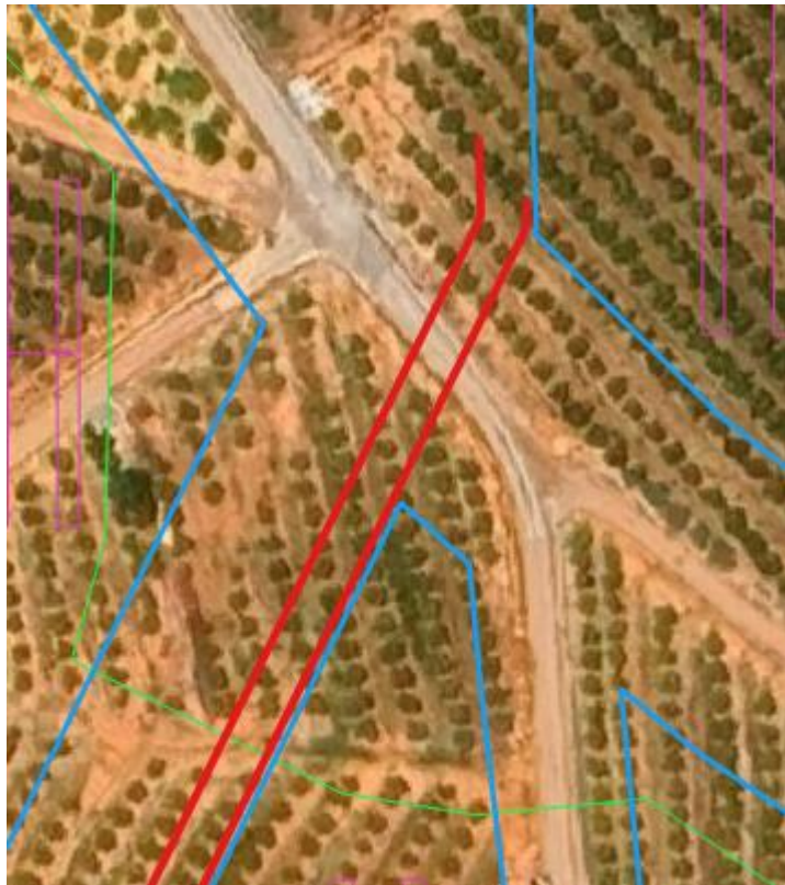
Figura 40 Cruzamiento de zanja de BT con la red de telecomunicaciones.
