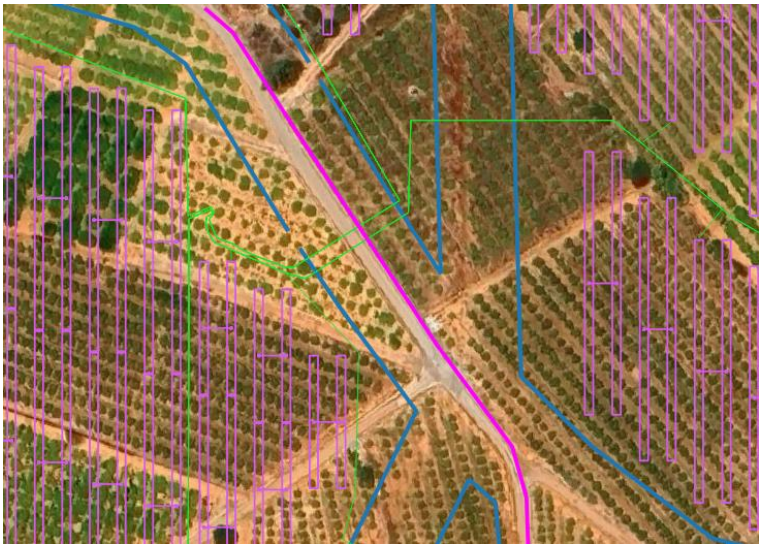
Figura 35. Cruzamientos de baja tensión con la canalización de regantes, 46156A00209013.
