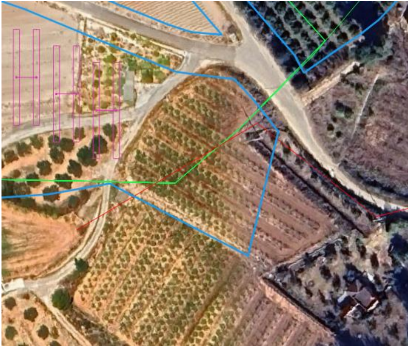
Figura 39 Cruzamientos de zanjas de BT con la red eléctrica perteneciente a I-DE.
