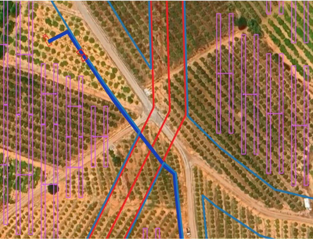
Figura 47 Representación de cruzamiento de MT con el Gasoducto
