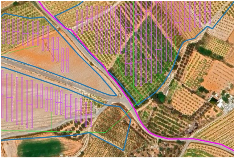
Figura 37. Cruzamiento de baja tensión con la canalización de regantes, 46156A01009020.
