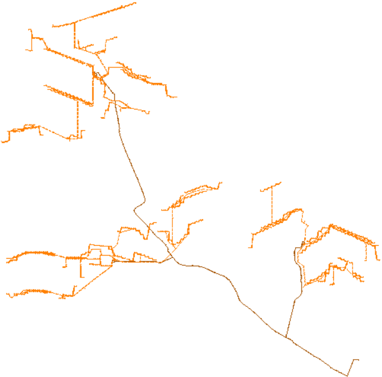
Imagen 12. Esquema de malla a tierra de PSFV LLANERA.
