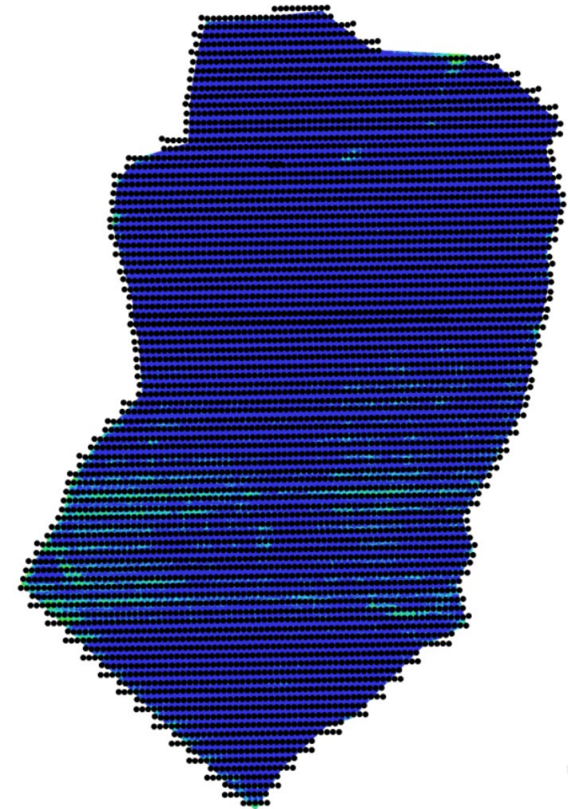
Figura 5: Posición GPS de las imágenes tomadas en vuelo
