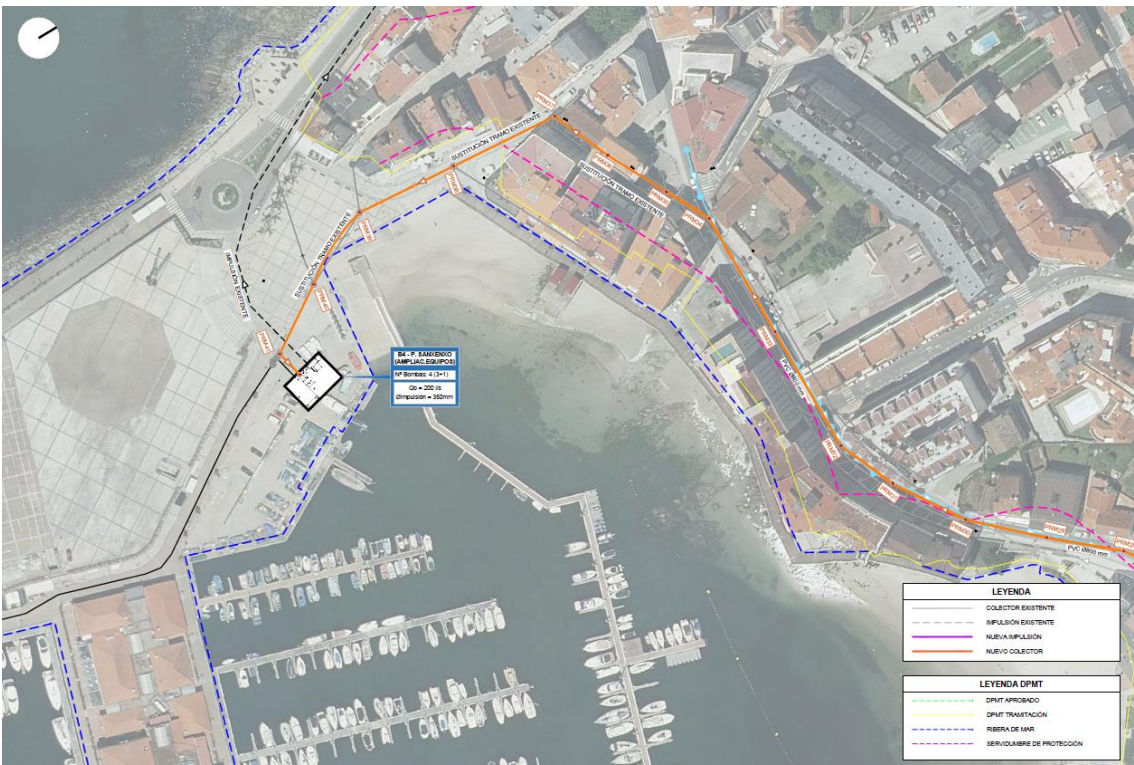
Trazado del colector a sustituir posterior al soterramiento de la Rúa de Madrid y desvío hacia el bombeo de Sanxenxo
