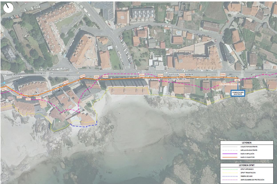
Tramo inicial de colector a sustituir en la banda de aparcamiento de la PO-308 y posterior desvío hacia la Rúa de Madrid
