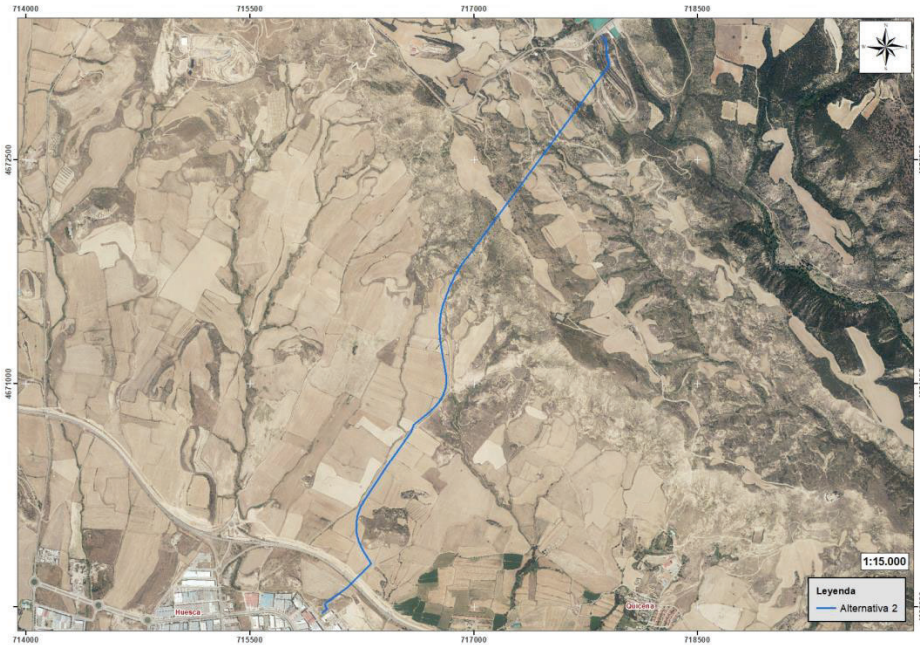
Trazado de la tubería, alternativa 2
