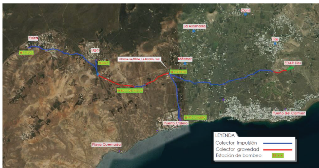
Figura 13: Red de colectores en la alternativa 2
