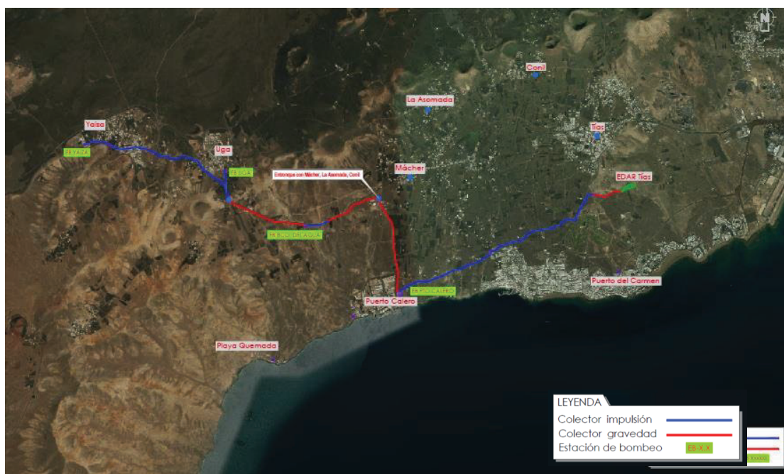
Figura 11: Red de colectores en la alternativa 1
