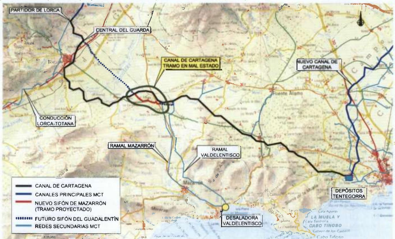
La actuación pretende renovar el tramo del Canal de Cartagena entre los hectómetros 254 y 305, sustituyendo el canal en lámina libre actual por un sifón en carga y la adecuación de las redotaciones de las tomas existentes en dicho tramo. Las obras objeto de este proyecto son:
