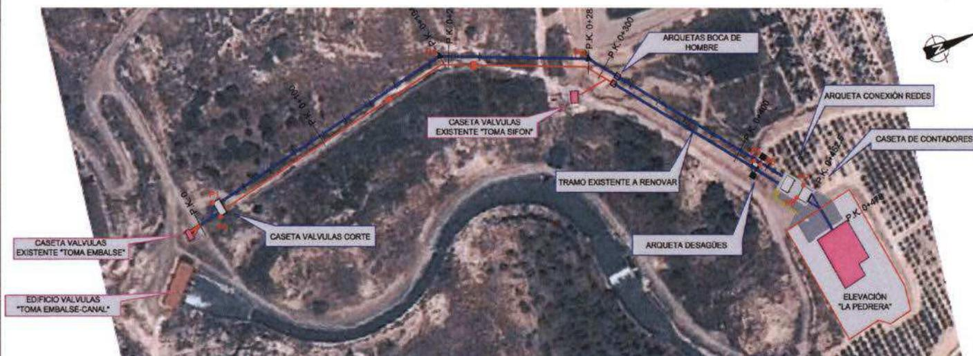
Se contempla la construcción de caseta de válvulas de corte cercana a otra existente donde se instalarán 4 válvulas motorizadas DN1500, 2 en cada línea de conducción, para el mando y control del caudal en ambas conducciones; también existirán 2 ventosas trifuncionales DN200 para toma y evacuación de aire; toda la instalación eléctrica, automatismo y telemando de válvulas.
