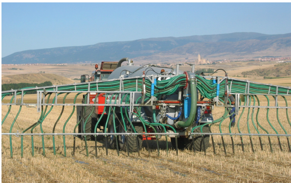
Imagen 10. Sistema de aplicación de purín mediante mangueras
