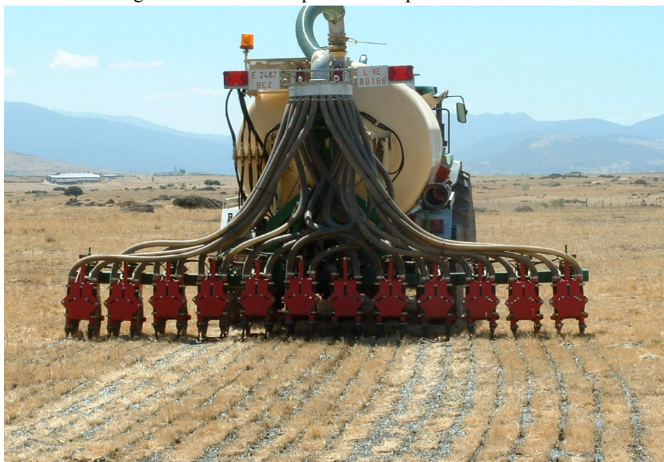
Imagen 11. Sistema de aplicación de purín mediante discos
