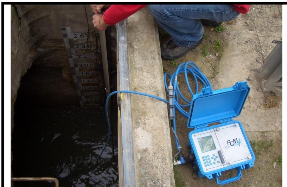
**Caudalímetro portátil con tecnología de correlación ultrasónica para canales y colectores parcialmente llenos. Cortesía de Lana Sarrate, S.A.**
