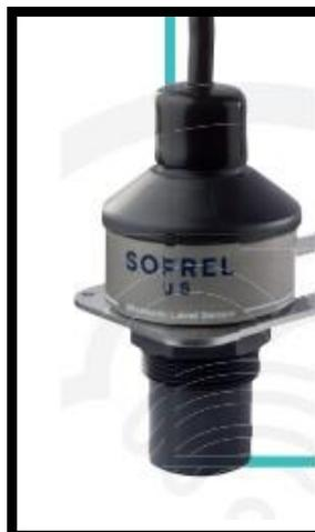
*Sensor de nivel por ultrasonidos (US). Sin contacto con las aguas residuales. Incorporado en el Registrador de datos (Data Logger) SOFREL DL4W LT-US. Rango de medida hasta 3 m. Estanqueidad: IP68 (100 días bajo 1 m de agua). Cortesía de «LACROIX SOFREL».*
