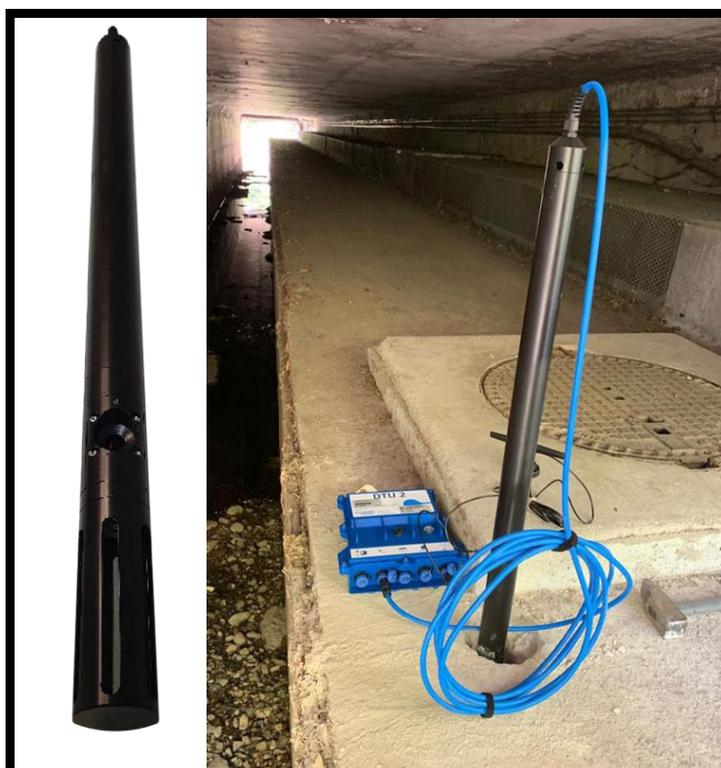
***Biosensor NODE para la monitorización de carga orgánica y DBO<sub>5</sub>. Es un Biosensor microbiológico autónomo, para la monitorización y análisis de agua superficial, residual o de uso industrial con detección temprana de eventos tóxicos.***
