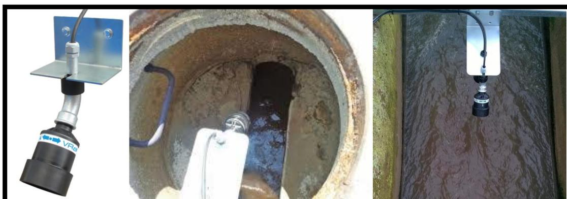
**Sensor de velocidad radar VRad-i sin contacto con las aguas residuales. Estanqueidad: IP68 (100 días bajo 1 m de agua). Rango de velocidades: 0,2-6,0 m/s (máximo 3 m de altura). Anchura máxima del canal por sensor: 1,5 m. En general el sensor de velocidad radar viene configurado para conectarse directamente al Registrador de Datos (Data Logger). Cortesía de «LACROIX SOFREL».**
