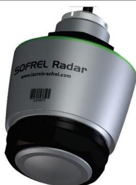
*Captador de nivel con tecnología Radar: SOFREL RADAR C11. Sin contacto con las aguas residuales. Para conectar tanto al Registrador de datos (Data Logger) SOFREL DL4W como a la estación remota S4W. Rango de medida hasta 8 m, con un error de medición  $\leq 5$  mm. Estanqueidad: IP68 (100 días bajo 1 m de agua). Cortesía de «LACROIX SOFREL».*
