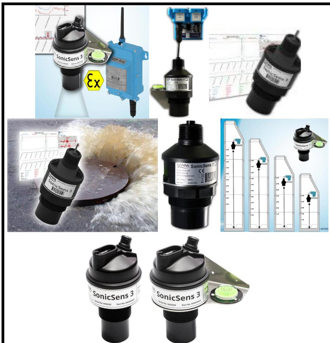
**Limnómetro (SONICSENS® 3) + Registrador de Datos (Data Logger). SONICSENS® 3 es un limnómetro digital ultrasónico autónomo sin contacto, para la detección de desbordamientos del sistema de saneamiento en episodios de lluvia, y la medición de nivel con cálculos de caudales y volúmenes. Rango 0,2 a 8 metros. Cortesía de Mejoras Energéticas, S.A.**
