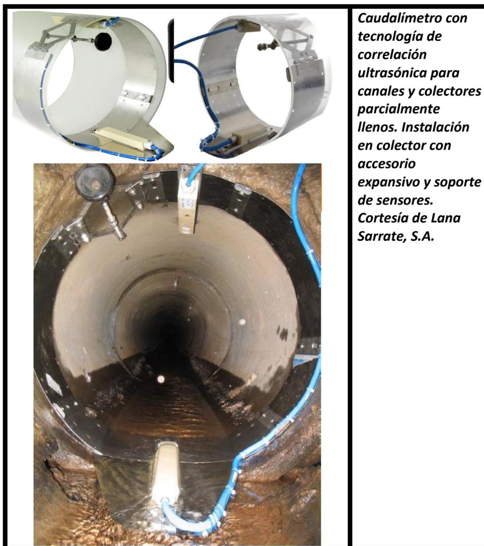
**Caudalímetro con tecnología de correlación ultrasónica para canales y colectores parcialmente llenos. Instalación en colector con accesorio expansivo y soporte de sensores. Cortesía de Lana Sarrate, S.A.**
