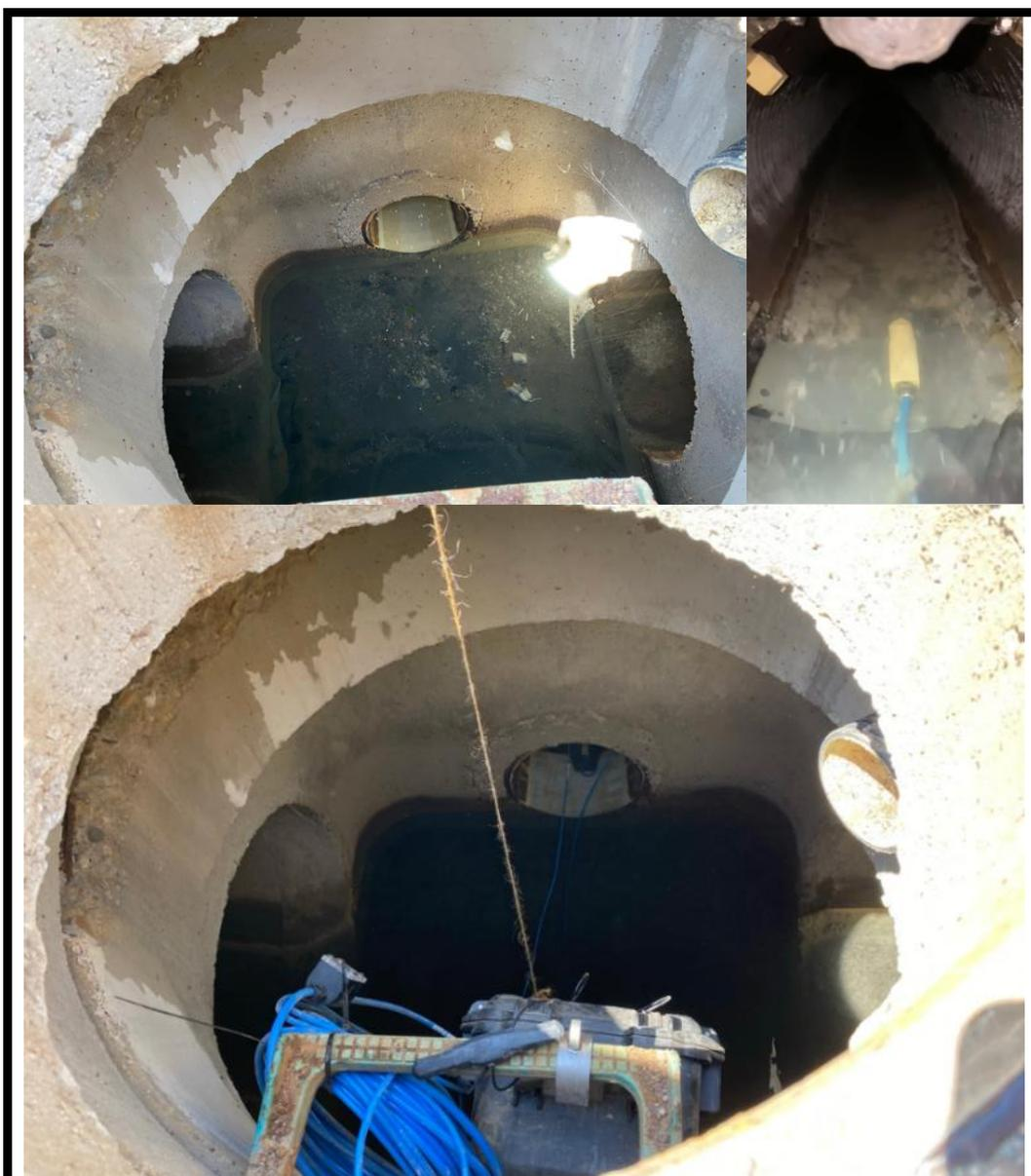
***Caudalímetro portátil con tecnología de correlación ultrasónica para canales y colectores parcialmente llenos. Instalación en colector de alcantarillado en la provincia de Zaragoza. Cortesía de Lana Sarrate, S.A.***
