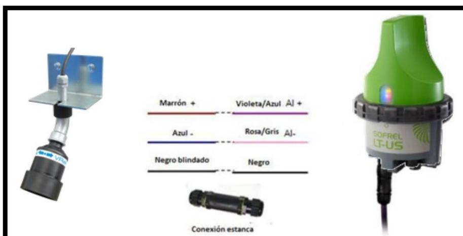
**Conexión de un sensor de velocidad radar VRad-i a un Registrador de Datos SOFREL LT-US (Data Logger). Estanqueidad: IP68 (100 días bajo 1 m de agua). Rango de velocidades: 0,2-6,0 m/s (máximo 3 m de altura). Anchura máxima del canal por sensor: 1,5 m. En general el sensor viene configurado para conectarse directamente al Registrador de Datos (Data Logger). Cortesía de «LACROIX SOFREL».**
