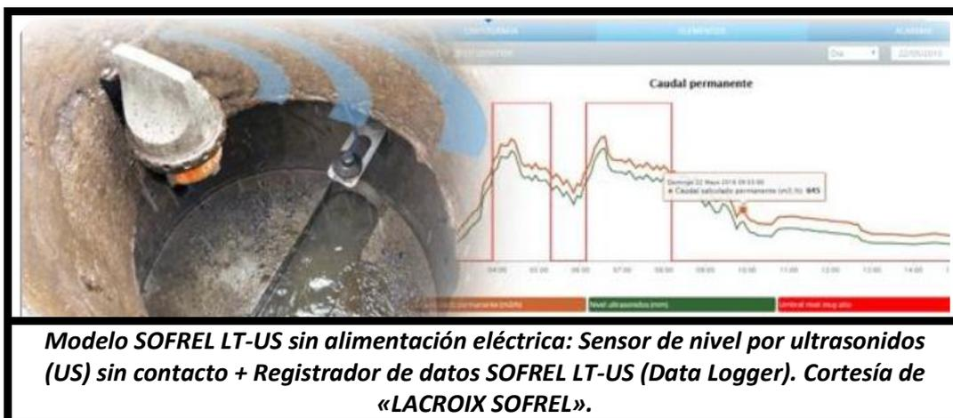
**Modelo SOFREL LT-US sin alimentación eléctrica: Sensor de nivel por ultrasonidos (US) sin contacto + Registrador de datos SOFREL LT-US (Data Logger). Cortesía de «LACROIX SOFREL».**
