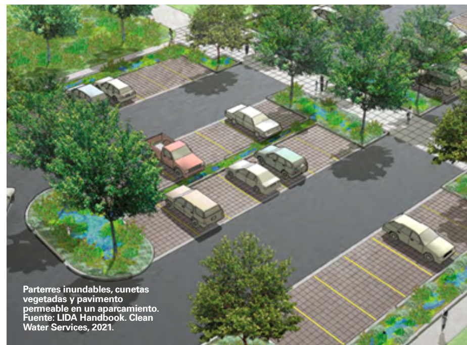
FIGURA 33: EJEMPLOS DE IMPLEMENTACIÓN DE SUDS EN APARCAMIENTOS.
