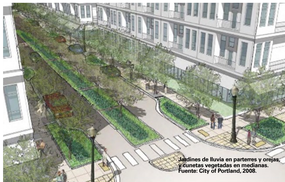
FIGURA 31: EJEMPLOS DE IMPLEMENTACIÓN DE SUDS EN CALLES.
