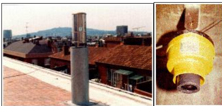
Figura 33 Ejemplos de sensores: Pluviómetro i limnómetro de ultrasonidos
