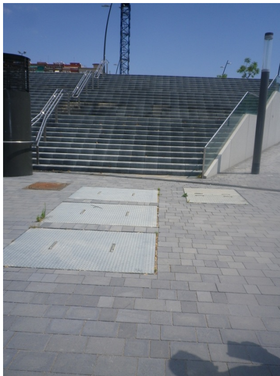
Figura 41 Tapas extracción bombas en medio de una plaza
