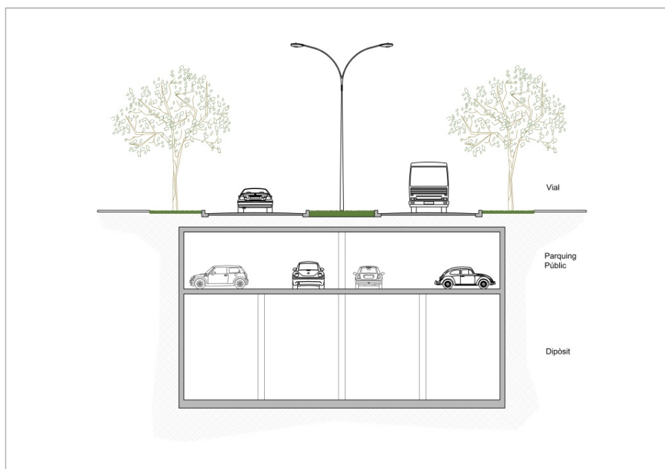
Figura 54 Esquema de implantación de tanque en zona urbana
