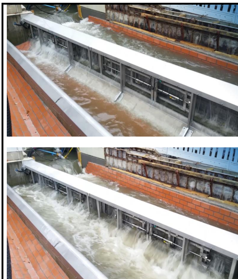
Funcionamiento de un Tamiz de aliviadero de limpieza automática tipo PEINE con sistema de limpieza lateral. Fuente: Hidrostantk.
