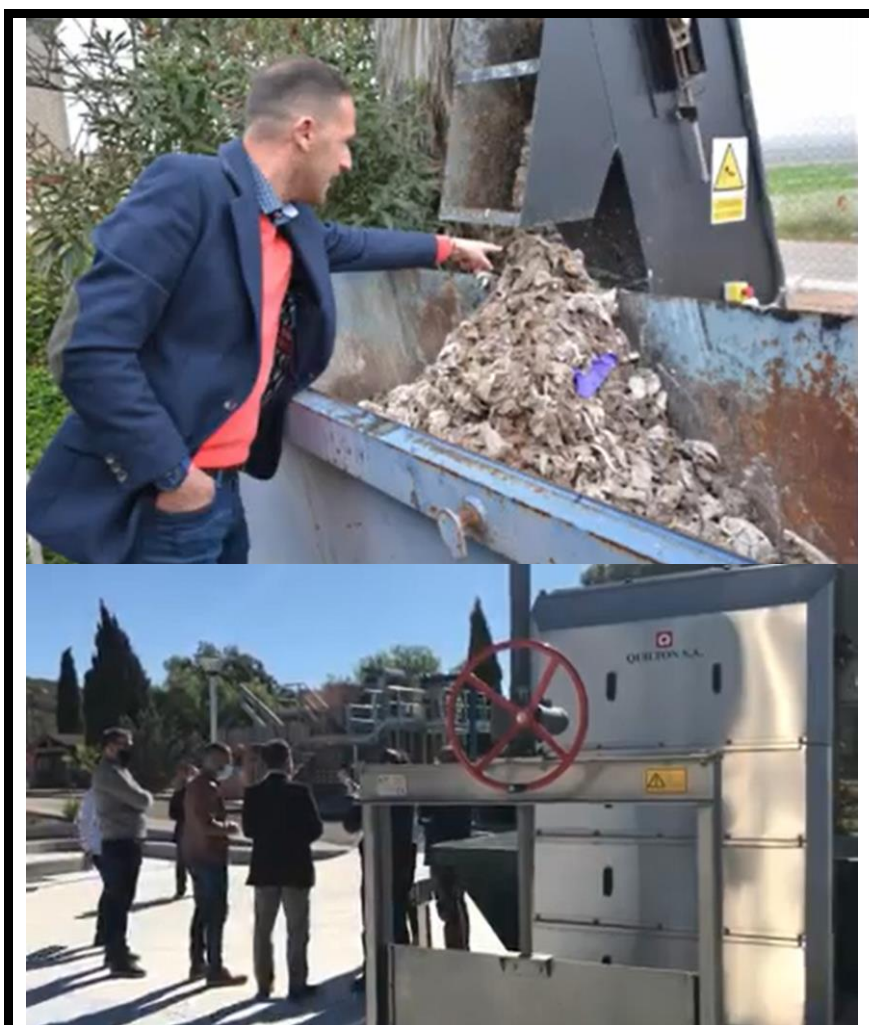
Planta de Pretratamiento de aguas pluviales en Pinoso (Alicante). Se ha desviado el colector de pluviales a la Planta de Pretratamiento donde se ha instalado un desbaste y una arqueta de sólidos donde se almacenará el residuo sólido, mientras que las aguas pluviales de escorrentía así tratadas serán devueltas al cauce del Rodrigillo. Octubre 2020. Cortesía del Ayuntamiento de Pinoso (Alicante).
