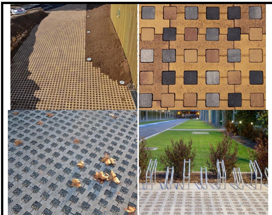
Pavimentos permeables (o drenantes). Pieza de 12 cm de espesor que crea una superficie de césped a la vez que soporta las cargas de vehículos. Aproximadamente el 40% del área de la pieza es área verde y el 60% distribuye las cargas a las capas inferiores. Cortesía de Breinco.
