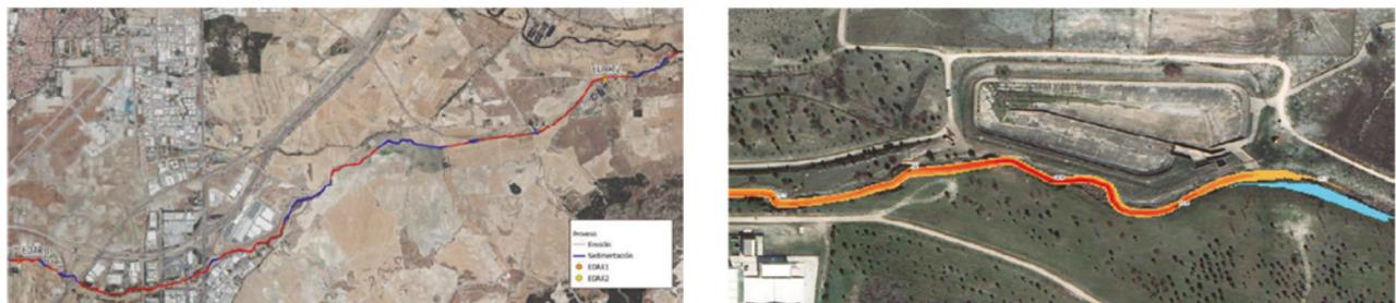
Figura A.4.10.4 (a) Modelo de erosión (en rojo) y sedimentación (en azul) para el tramo comprendido entre las EDARs y (b) detalle de los procesos erosivos en un tramo con intensidad moderada (naranja) y severa (rojo).
