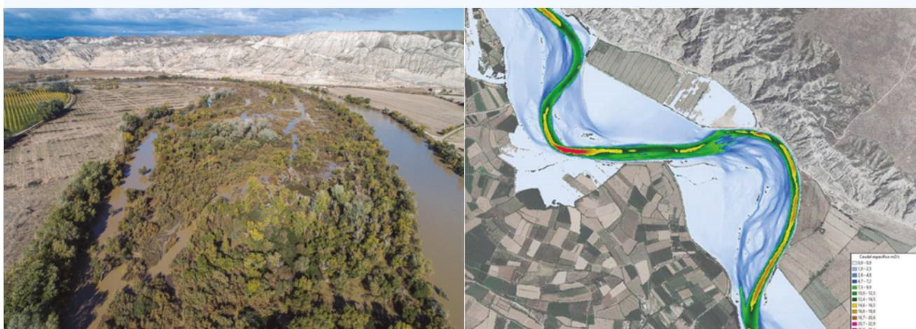
Figura A.2.3.4. Mejana del Tambor. (a) Ramales de libre circulación en funcionamiento y (b) simulación de caudal específico, caudal (m<sup>3</sup>/s) por unidad de ancho (m<sup>2</sup>). Fuente: CHE
