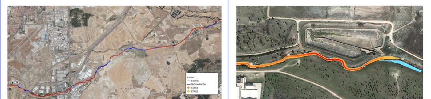
Figura A.4.10.4 (a) Modelo de erosión (en rojo) y sedimentación (en azul) para el tramo comprendido entre las EDARs y (b) detalle de los procesos erosivos en un tramo con intensidad moderada (naranja) y severa (rojo).
