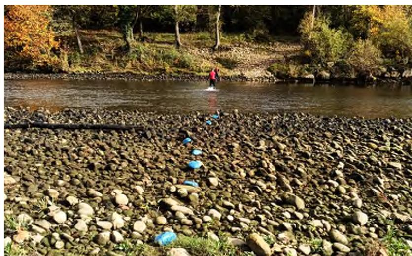
Figura. A.4.2.3. (a) Evolución de la longitud de orillas erosivas en el tramo bajo del río Nalón (Trubia-Peñaullán), según la cartografía realizada en 14 fechas entre 1945 y la actualidad; b) Colocación de cantos marcados con RFID en las inmediaciones de la localidad de Valduno.
