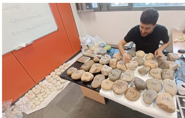
Figura A.4.2.2 (a) Orilla erosiva en las inmediaciones de la localidad de Grullas en el tramo bajo del río Nalón.; (b) Preparación y caracterización de clastos para su posterior colocación en el lecho del río Nalón. Fuente: CHC.
