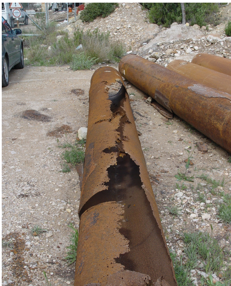
Figura 7.3.1. Detalle del estado de un tubo de acero normal corroído a los pocos años de su instalación en un acuífero con agua salada. Autor: Juan Antonio Hernández Bravo.
