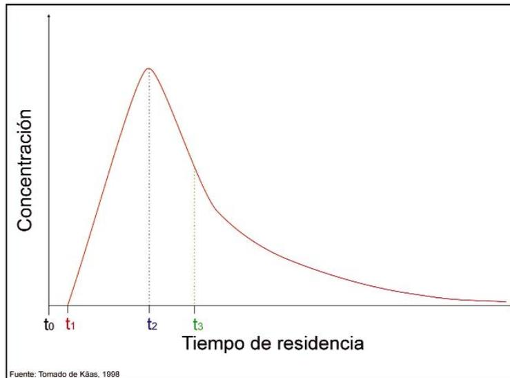
**Figura 68:** Curva de concentración-tiempo para un ensayo con trazadores artificiales.
