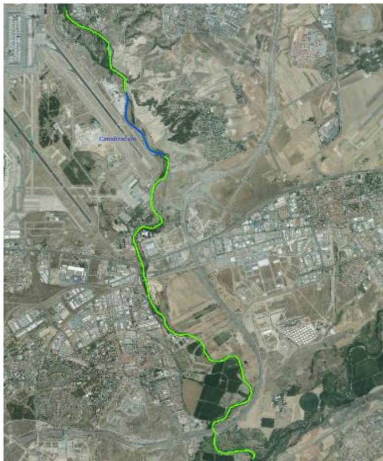
**Figura 1- Ejemplo de caso en el que parte (en azul) de un tramo hidromorfológico homogéneo (en verde) de una masa de agua no alcanza una longitud suficiente como para ser considerada por sí misma un tramo independiente.**
