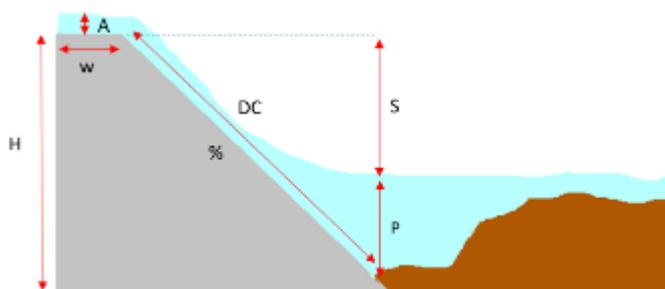
**Figura 11.-Variables para obstáculos tipo paso sobre paramento**
