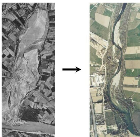
**Figura 20.-Ejemplo de cambio de tipo morfológico en planta: divagante a sinuoso.**
