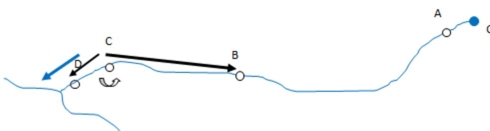
Caso 3. Eliminación o permeabilización de los obstáculos B y C. Longitud permeabilizada total= D-A
