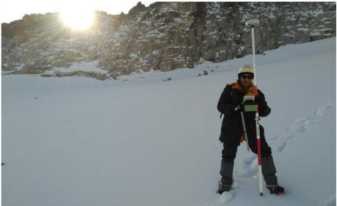
*Toma de datos de cota superficial mediante GPS en traza de perfil
