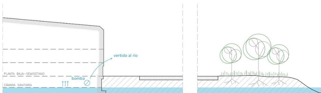
Fig. 19: Agua procedente del nivel freático.
