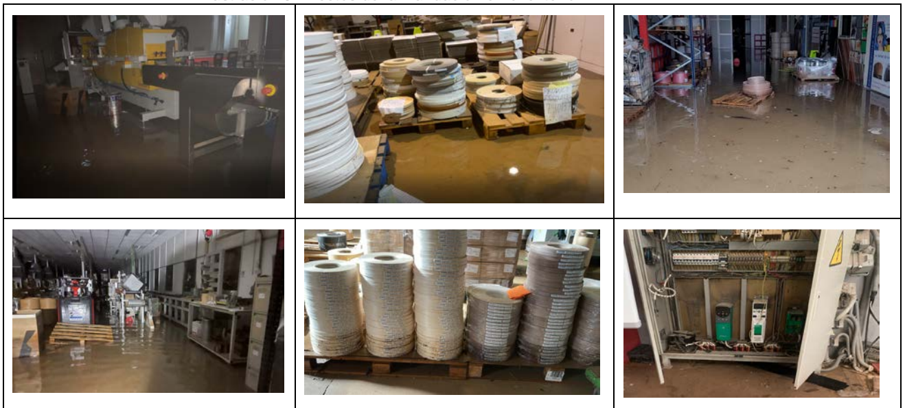
Ilustración 10. Efectos de la inundación en el interior de las naves.
