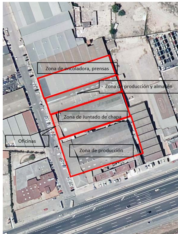
Ilustración 33. Croquis de la instalación.
