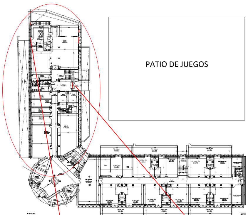
Figura 30. Puertas de acceso a cocina y escaleras a planta inferior, y salidas al patio de juegos
