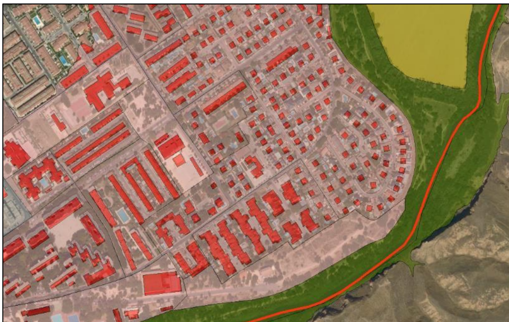
Figura 37.- Detalle de la diferenciación entre los usos del suelo “urbano concentrado” y “asociado a urbano” ya realizada en el subtramo ARPSI ES030-08-03-01. DH Tajo, periodo de retorno de 500 años
