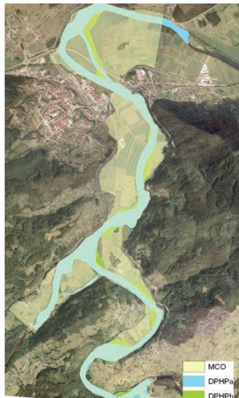
Figura 31.- Resultado de la modelización hidráulica de la MCO y límites del DPHPa y DPHPb definidos en el análisis histórico y geomorfológico. Fuente: Guía del SNCZI
