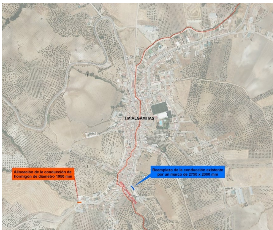
Figura 17: Actuaciones de mejora del drenaje de los arroyos Los Ballesteros y Calderón a su entrada en el soterramiento de Algámitas
