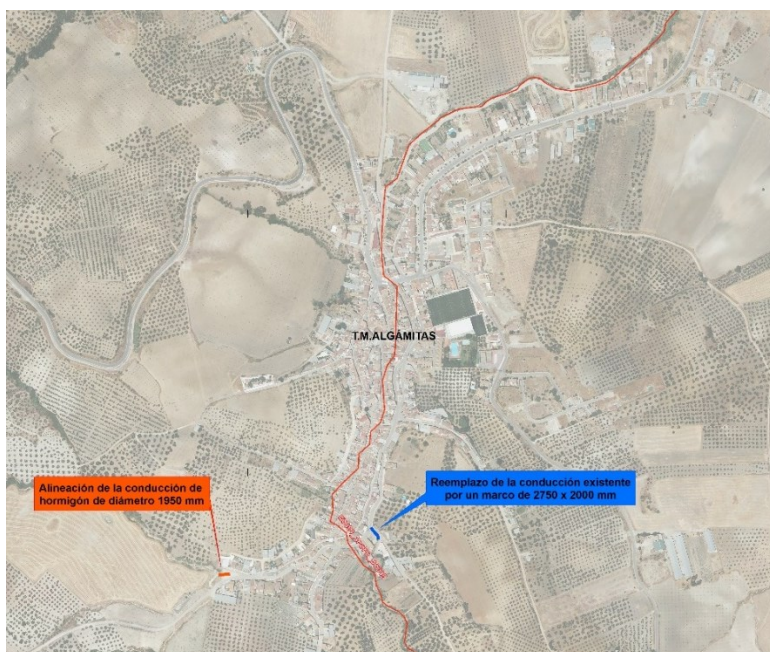
Figura 3: Actuaciones de mejora del drenaje de los arroyos Los Ballesteros y Calderón a su entrada en el soterramiento de Algámitas
