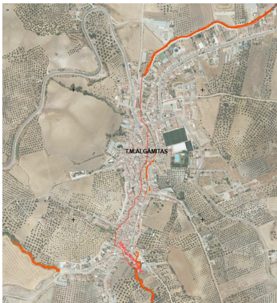
Figura 29: Superficie de alta peligrosidad en Algámitas, alternativa 0
