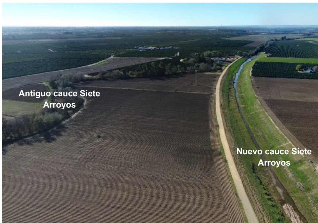
Figura 11. Imagen aérea del nuevo y antiguo cauce del Siete Arroyos, visto hacia aguas abajo. Se indica también la situación del muro de defensa. Fuente: José Fresco Fresco, Google Maps.
