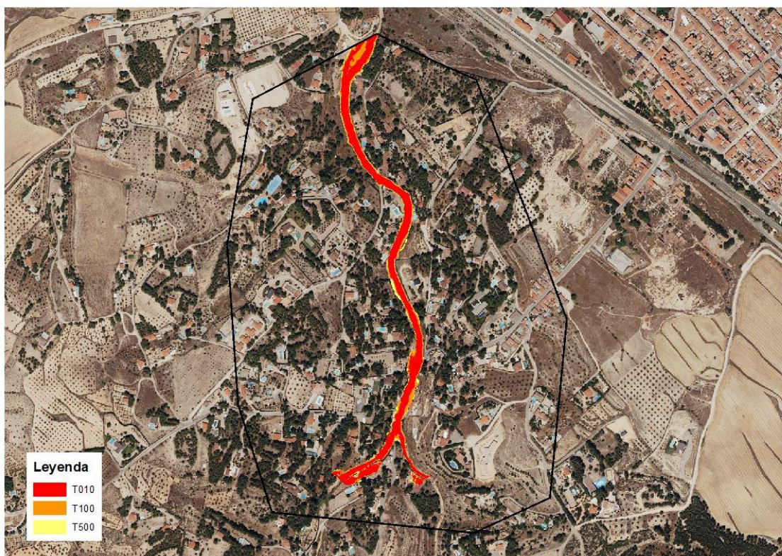
Figura 15. Zonas inundables para diferentes periodos de retorno calculadas para la Alternativa 0
