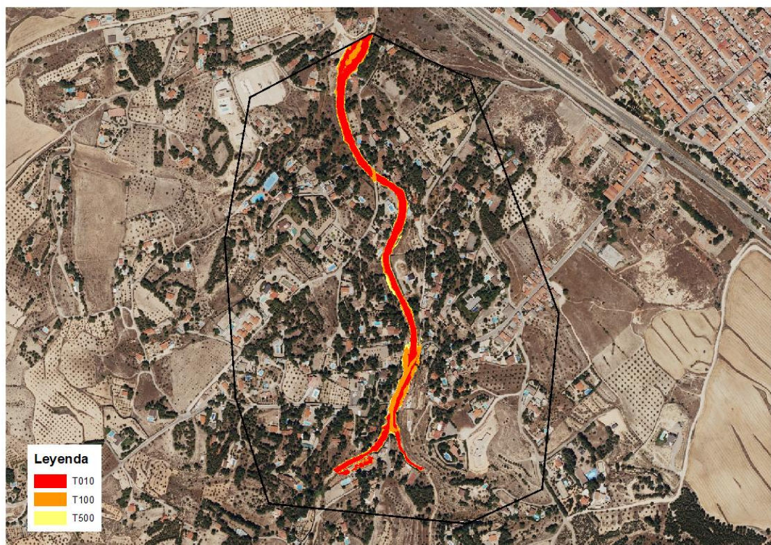
Figura 18. Zonas inundables para diferentes periodos de retorno calculadas para la Alternativa 1
