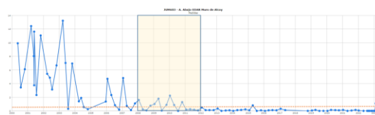
Concentración de amonio en la estación JUM603 Aguas debajo de la EDAR Muro de Alcoy.
