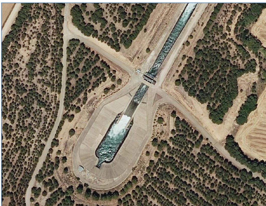
Figura 6. Ortoimagen PNOA de la cámara de carga por la que el ATS se interna en el túnel de Talave.
