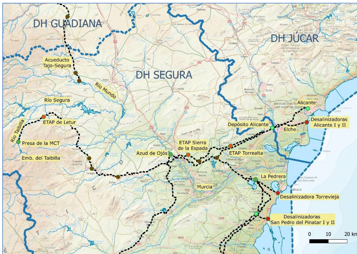
Figura 57. Mapa de la red general de la MCT, mostrando la transferencia a la demarcación hidrográfica del Júcar. Los puntos coloreados corresponden a: verde claro, depósitos; verde oscuro, presas y azudes; naranja, ETAP; rojo, desalinizadoras, y marrón, conexiones de diverso tipo.
