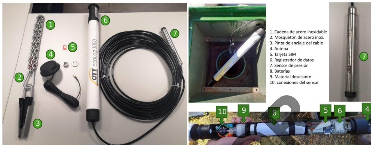
Imagen 69. Piezómetro OTT Ecolog 1000 con tarjeta de comunicación SIM. Dependiendo de la frecuencia de muestreo, la autonomía de su batería puede llegar a durar de 5 a 10 años
