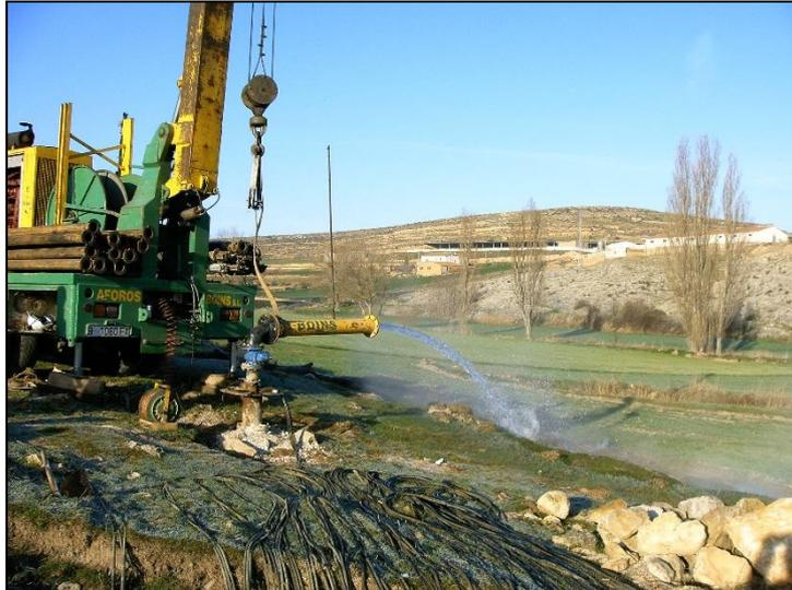
**Ilustración 5: Ensayo de bombeo en el País Vasco**
